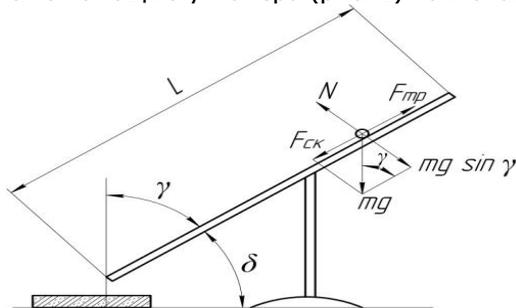
Рис. 1. Схема для определения коэффициента трения покоя семян
