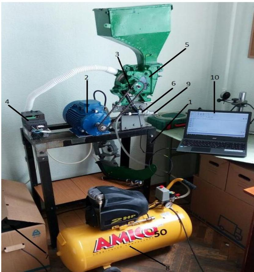
Рис. 6. Лабораторная установка для исследований пневматических высевающих аппаратов: 1 – рама, 2 – электродвигатель постоянного тока, 3 – приводная цепь, 4 – частотный преобразователь, 5 – экспериментальный высевающий аппарат, 6 – семяпровод, 7 – вакуумная установка с регулятором разрежения, 8 – компрессор, 9 – датчики измерения скорости семян на выходе из семяпровода, 10 – персональный компьютер.
