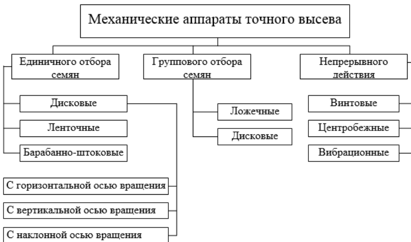
Рисунок 5 - Классификация механических аппаратов точного высева семян
