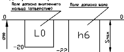
Рисунок 1. Схема расположения полей допусков соединения «внутреннее кольцо – вал».
