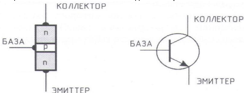
Рисунок 2.1. Устройство n-p-n транзистора и его условное обозначение
