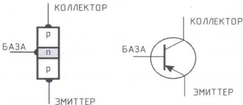
Рисунок 2.2 Устройство p-n-p транзистора и его условное обозначение
