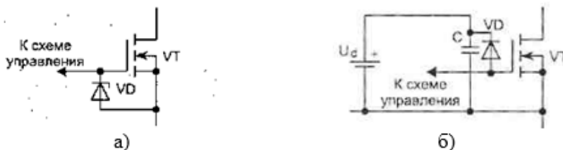
Рис. 2.3.5. Схемы ограничения напряжения на затворе.
