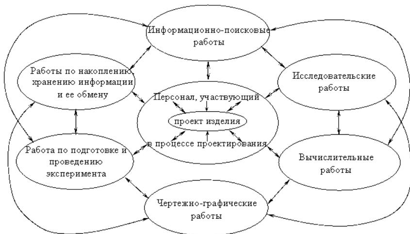
Рис.1.2. Модель, характеризующая взаимосвязь основных видов работ при проектировании новых образцов
