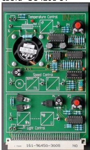
2. Экспериментальная плата "Системы регулирования температуры, скорости и света" SO4201-5V
