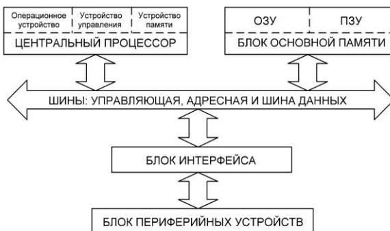
устройства (чаще всего это наборы микросхем) выполняют функции *моста* между шинами.
