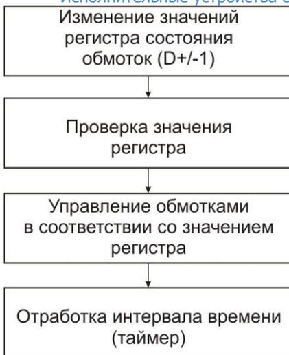
Рисунок 3 – Структура программы управления шаговым двигателем
