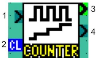
Серые клеммы предназначены для подключения двоичных сигналов, зеленые – для аналоговых, синие клеммы обозначают вход для сброса значений ФБ.
