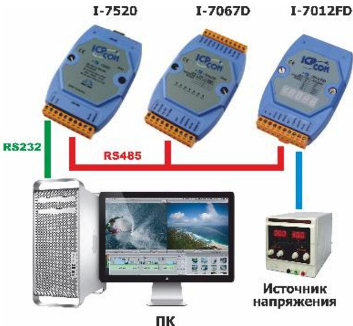
Рисунок 2 – Подключение модулей ввода/вывода к ПК
