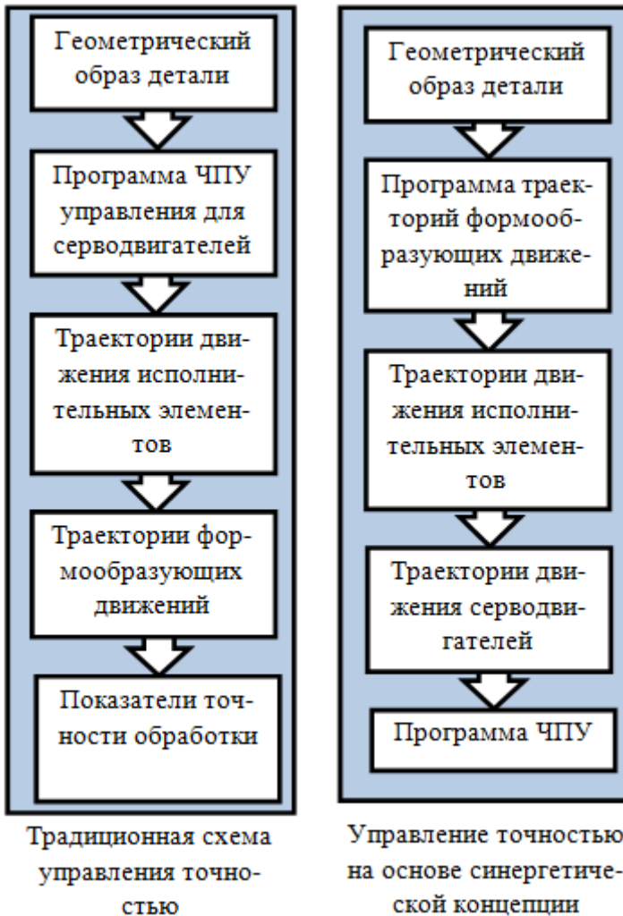
Рис. 42. Схемы управления точностью обработки: традиционная, и на основе синергетической концепции
