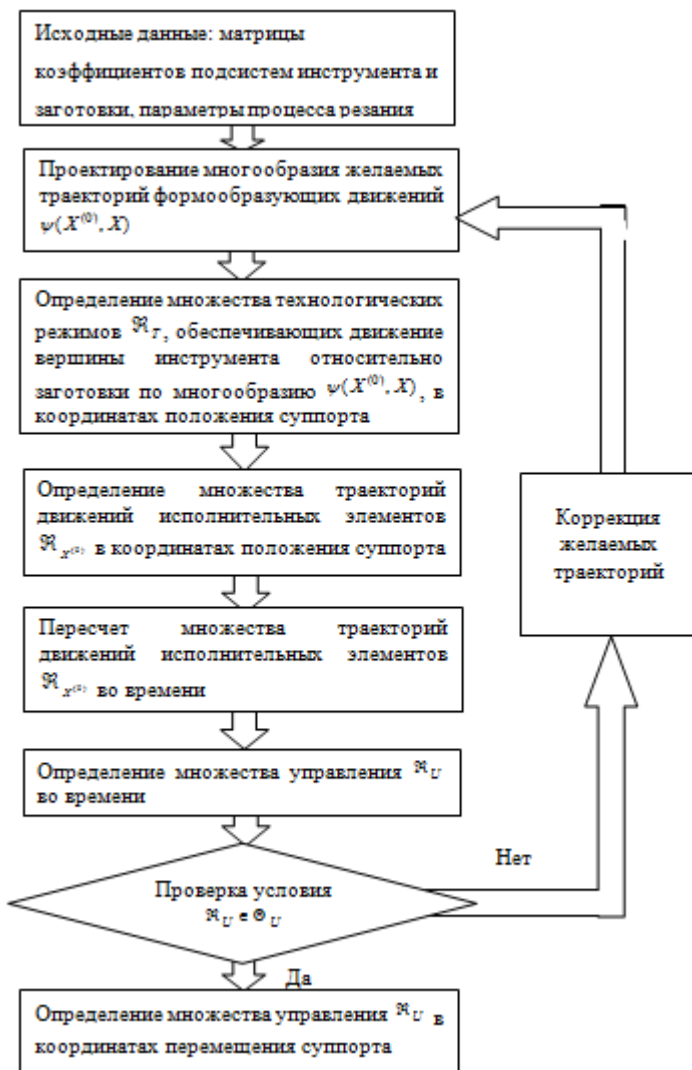
Рис.58. Обобщенный алгоритм определения инвариантного многообразия траекторий формообразующих движений \psi , обеспечивающих заданные показатели геометрического качества детали
