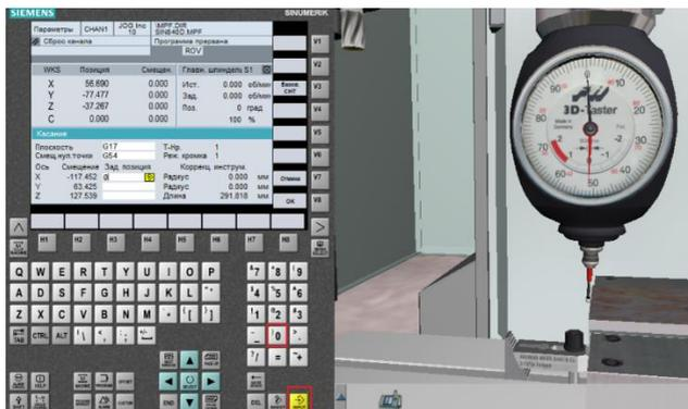
5) Коснитесь наконечником измерительного щупа передней грани детали для определения положения нулевой точки детали по оси Y.
