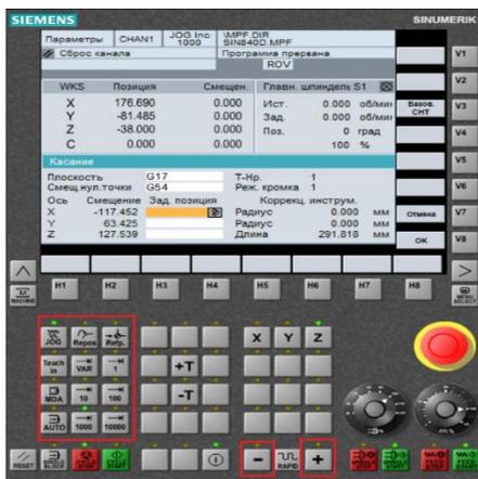
4) Теперь ось шпинделя находится точно над кромкой детали. Это положение должно быть воспринято системой ЧПУ как 0 по оси X.
