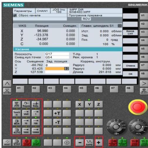
б) Теперь ось шпинделя находится точно над кромкой детали. Это положение должно быть воспринято системой ЧПУ как 0 по оси Y.
