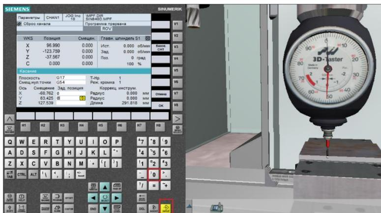
7) Коснитесь наконечником измерительного щупа передней грани детали для определения положения нулевой точки детали по оси Z.
