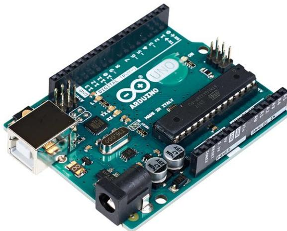
Рисунок 1 – Контроллер Arduino UNO R3
