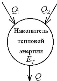
Рисунок 2.2 – Условная схема процесса смешения
