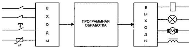
Рисунок 1 - Принцип работы ПЛК
