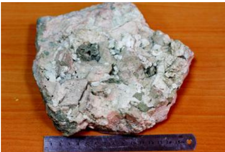
Микроклин - \text{K}[\text{AlSi}_3\text{O}_8] класс силикатов группы полевых шпатов, калинатровый полевой шпат, алюмосиликат калия каркасного строения.
