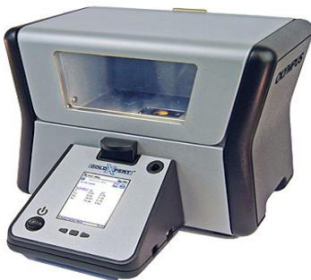
Рисунок 5. Спектроскоп для определения драгоценных металлов
