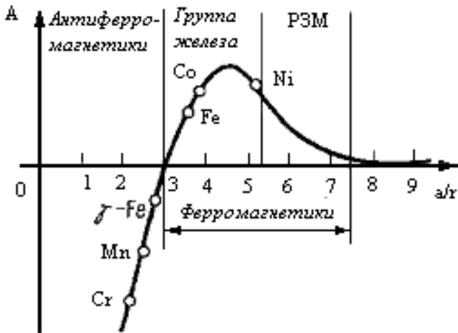
Рис. 2.48 Схематическая зависимость обменного интеграла A от отношения a/r
