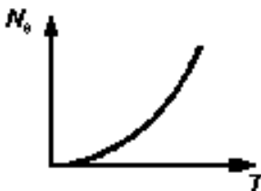
Рис.1.11. Зависимость числа электронов N_e , испускаемых нагретым металлом в единицу времени, от абсолютной температуры.
