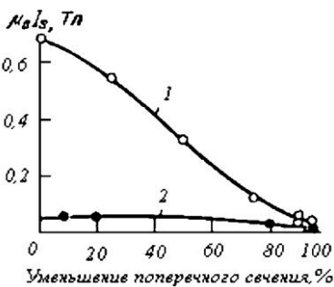
Рис.4 Влияние холодной деформации на \mu_0 I_s
