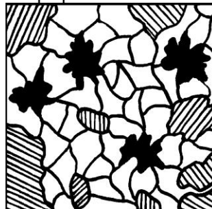
Рис.10. Схема микроструктуры феррито-перлитного ковкого чугуна. Феррит, перлит и хлопьевидный графит. \times 200
