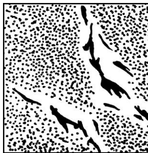
Рис.3. Схема микроструктуры эвтектического белого чугуна. Ледебурит. \times 350
