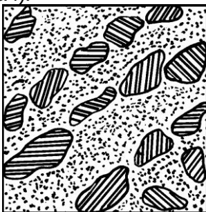
Рис.2. Схема микроструктуры доэвтектического белого чугуна. Ледебурит и перлит. \times 350
