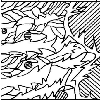
Рис.9.4. Схема микроструктуры наплавленного металла (сталь 08, феррит и перлит; и стали марки 5 (0,35%С) на участке неполного расплавления (феррит и перлит). \times 250
