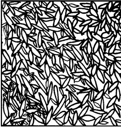
Рис.3.6.Схема микроструктуры доэвтектоидной стали 45 после полной закалки в воде. Мартенсит. \times 500
