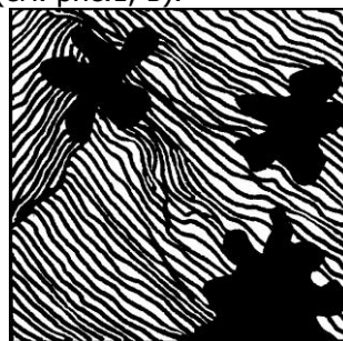
Рис.9. Схема микроструктуры перлитного ковкого чугуна. Перлит и хлопьевидный графит. \times 600
