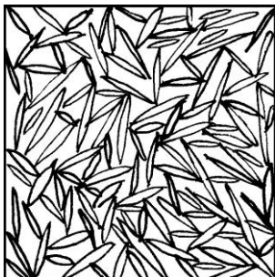
Рис.7. Схема микроструктуры, легированной стали мартенситного класса марки 20X13 после нормализации от 1050°C. Мартенсит и остаточный аустенит. \times 600 . (Травление в электролите, содержащем 5-10 г щавелевой кислоты и 100 мл воды, при плотности тока 0,1 А/см 2 в течение 60-80 с)
