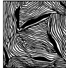
Рис.6. Схема микроструктуры перлитного серого чугуна. Перлит и пластинчатый графит. ×600
