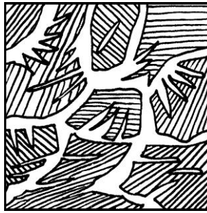
Рис.6. Схема микрострук- туры доэвтектоидной углероди- стой стали после сильного пере- грева при отжиге. Феррит в виде игл (видманштеттова структура). \times 500
