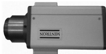
Рис.7. Видеокамера с установленным окуляр-переходником.
