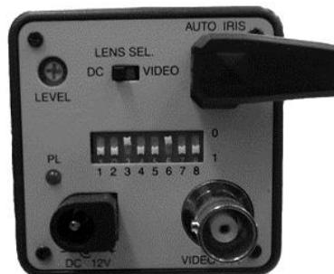
Рис.10. Панель установок на видеокамере
