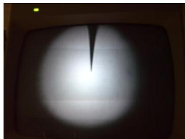
Рис.11. Изображение заточенного зонда в мониторе
