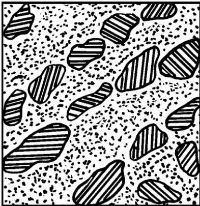
Рисунок 2.- Схема микроструктуры доэвтектического белого чугуна. Ледебурит и перлит.  $\times 350$
