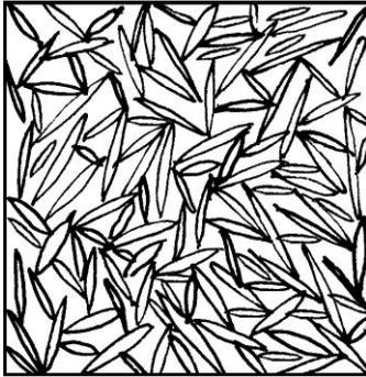
Рисунок 7.- Схема микроструктуры легированной стали мартенситного класса марки 20X13 после нормализации от 1050<sup>o</sup>C. Мартенсит и остаточный аустенит.  $\times 600$ . (Травление в электролите, содержащем 5-10 г щавелевой кислоты и 100 мл воды, при плотности тока 0,1 А/см<sup>2</sup> в течение 60-80 с)
