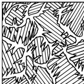
Рисунок 5.- Схема микроструктуры стали марки 5 на участке перегрева. Видманштеттова структура, перлит (квазиэвтектоид) и феррит.  $\times 250$
