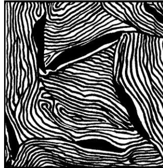
Рисунок 6.- Схема микроструктуры перлитного серого чугуна. Перлит и пластинчатый графит.  $\times 600$
