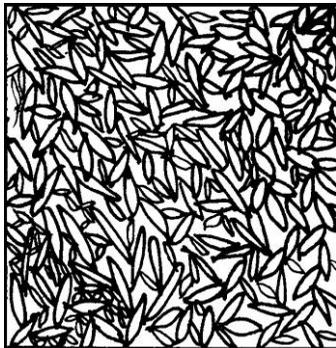
Рисунок 6 - Схема микроструктуры доэвтектоидной стали 45 после полной закалки в воде. Мартенсит.  $\times 500$
