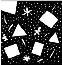
Рисунок 15ю- Схема микроструктуры баббита марки Б83 в литом состоянии. SnSb,  $\text{Cu}_6\text{Sn}_5$  и тройная эвтектика ( $\alpha + \text{SnSb} + \text{Cu}_6\text{Sn}_5$ ).  $\times 200$
