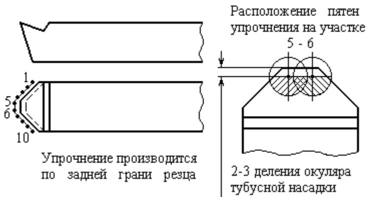
Рисунок 1 - Схема упрочнения фасонного резца
