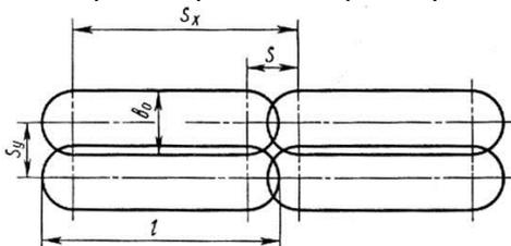
Рис. 49. Схема наложения пятен при использовании цилиндрической оптики
