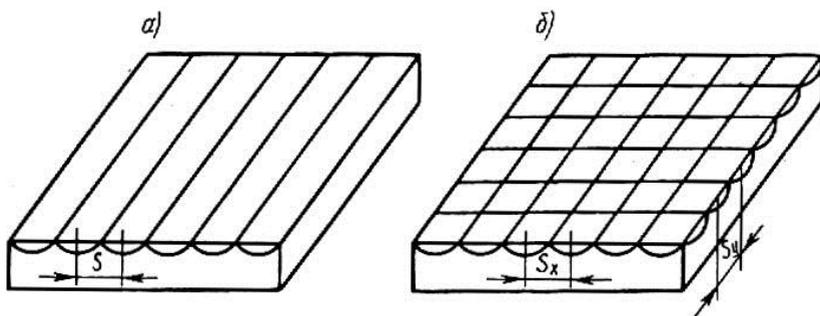
Рис. 52. Схемы наложения полос на плоской поверхности
