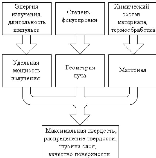
Рисунок 4 - Основные параметры процесса лазерной обработки материалов
