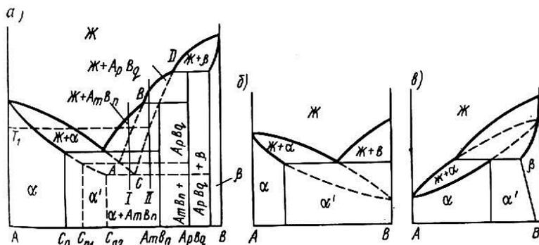
Рис.40. Образование метастабильных твердых растворов  $\alpha'$  в сплавах:
