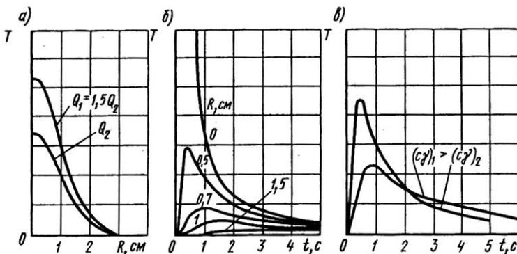
Рис. 24. Распределение температур в полубесконечном теле при действии мгновенного точечного источника: а — различное количество введенной теплоты  $Q$ ; б — различное расстояние  $R$  до точки 0; в — различная теплоемкость материала  $c_\gamma$
