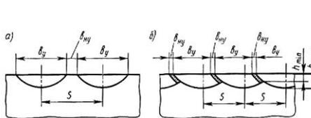
Рис. 47. Схемы наложения нескольких пятен при  $K_n > 1$  (а) и  $K_n < 1$  (б)
