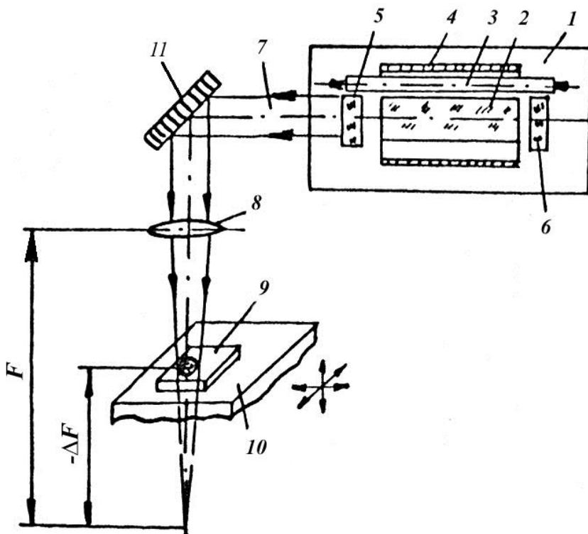
Рисунок 1 - Оптическая схема технологической установки
