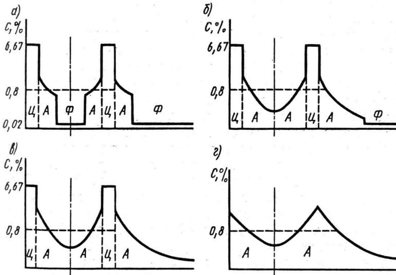
Рис. 35. Неоднородности структуры в доэвтектоидной стали
