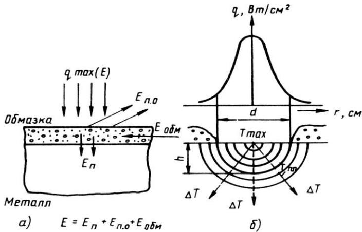
Рис. 59. Поглощение энергии при лазерной химико-термической обработке (а) и температурное поле в зоне воздействия лазерного излучения (б);  $E$  - энергия излучения ОКГ,  $E_{н.о}$  - энергия, отраженная поверхностью;  $E_{обм}$  - энергия, поглощенная обмазкой;  $E_n$  - полезная энергия, обеспечивающая оплавление поверхности;  $T_{пл}$  - изотерма плавления;  $T_{max}$  - максимальная температура поверхности
