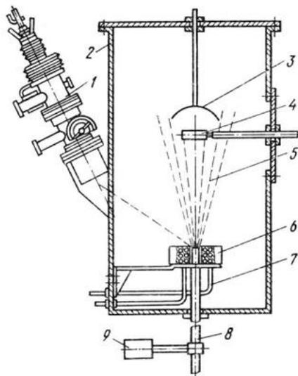
Рисунок 1 - Установка для осаждения покрытий способом КИБ:
