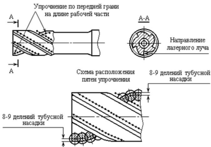
Рисунок 2 - Схема упрочнения концевой фрезы
