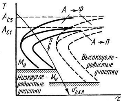
Рис. 37. Диаграммы распада неомогенного аустенита в доэвтектоидной стали
