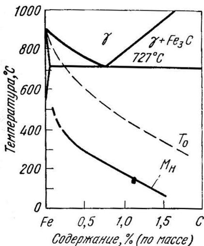
Рис. 12. Зависимость температуры равенства энергии Гиббса аустенита и мартенсита одинакового состава ( $T_0$ ) и температуры  $M_H$  от содержания углерода в системе Fe-C
