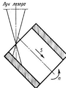
Рис. 55. Схема упрочнения внутренней поверхности цилиндра лучом, направленным под углом к оси втулки
