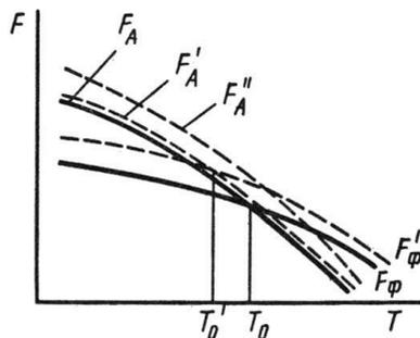
Рис. 33. Температурные зависимости свободной энергии недеформированных феррита и аустенита ( $F_\phi$ ,  $F_A$ ) и деформированных феррита и аустенита ( $F'_\phi$ ,  $F'_{A'}$ ,  $F''_{A'}$ )
