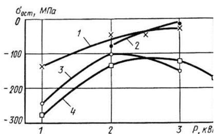
Рис. 44. Изменение остаточных напряжений в центре полосы в зависимости от мощности излучения для различных сплавов железа: 1 — сталь У8; 2 — железо; 3 — сталь 40X; 4 — сталь 45
