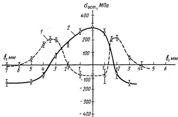
Рис. 43. Распределение поперечных остаточных напряжений на поверхности стали У8 по ширине полосы на различном расстоянии от центра полосы после обработки непрерывным  $\text{CO}_2$ -лазером по режимам: 1 —  $P = 1$  кВт,  $v = 41,8$  мм/с; 2 —  $P = 0,5$  кВт,  $v = 33,3$  мм/с
