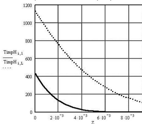
Рисунок 1 - Пример графического вида результата расчета температуры материала на стадии нагрева в зависимости от глубины  $Z$
