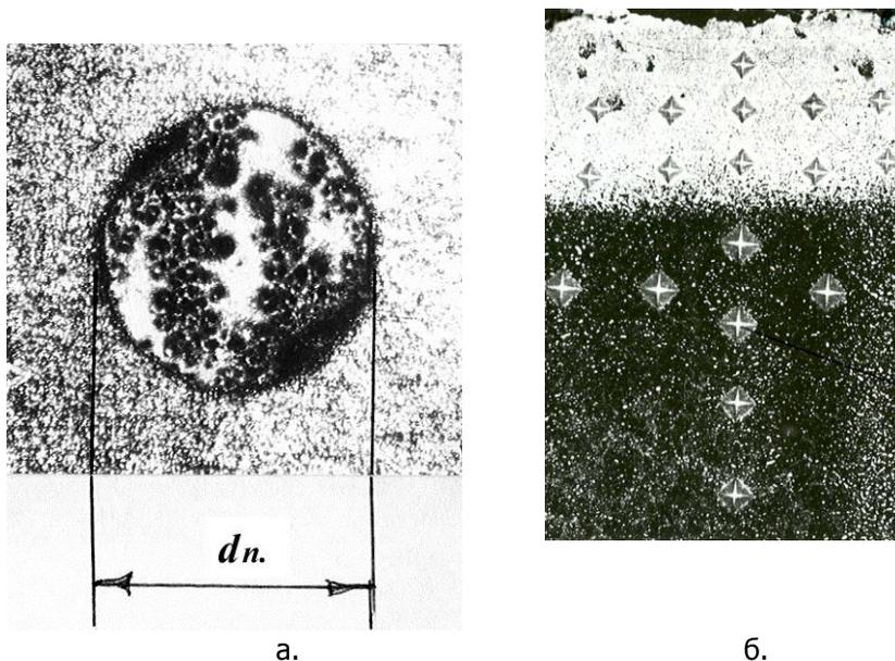
Рисунок 3 - Внешний вид пятна упрочнения (а,  $\times 14$ ) и микроструктура лазерно-закаленного слоя на стали X12Φ1 (б,  $\times 500$ ) при использовании технологической установки «Квант-16»
