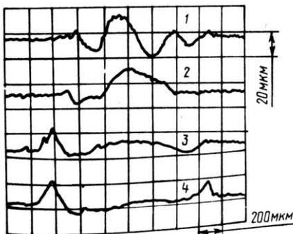
Рис. 67. Изменение профиля поверхности при лазерном борировании с различной энергией импульса, Дж:
