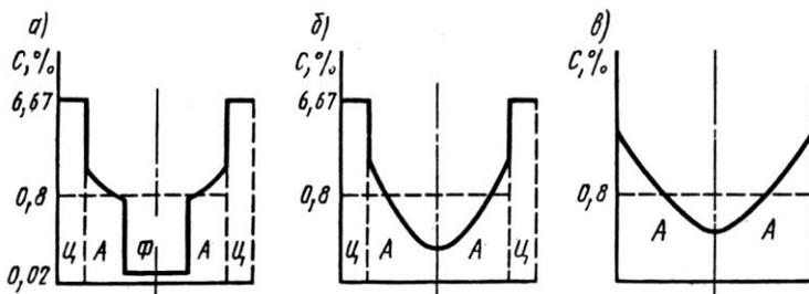
Рис. 34. Неоднородности структуры в эвтектоидной стали
