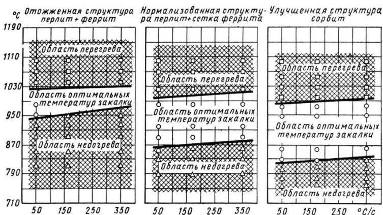
Рис. 9. Зависимость интервала оптимальных температур закалки стали 50 от скорости нагрева и исходной структуры
