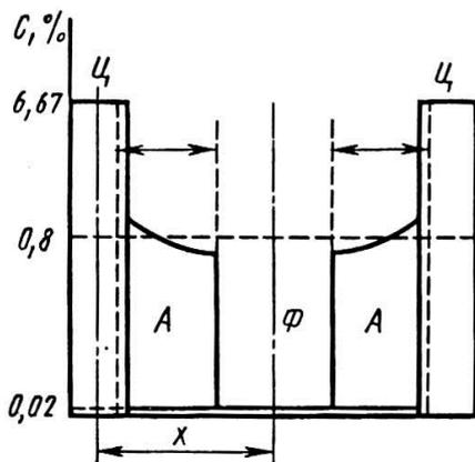
При лазерной закалке без оплавления очень важной является фаза нагрева, так как в процессе последующего скоростного охлаждения фиксируются стадии превращений при нагреве. При нагреве сплавов железа в точке  $A_{C1}$  начинается превращение перлита в аустенит. Наиболее вероятным местом за-
