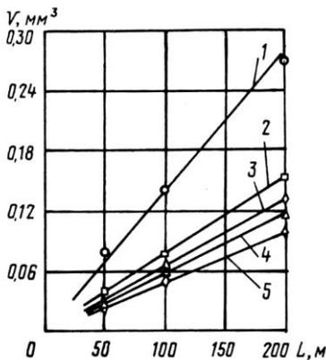
Рис. 69. Изменение объема вытертой лунки в процессе испытаний на машине Шкода-Савина: 1 - без упрочнения; 2 - ЛТО ( $H_{0,981} = 9500\text{МПа}$ ); 3 - легирование бором ( $H_{0,981} = 13600\text{МПа}$ ); 4 - легирование бором ( $H_{0,981} = 15600\text{МПа}$ ); 5 - легирование бором ( $H_{0,981} = 18900\text{МПа}$ )
