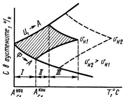
Рис. 31. Изменение концентрации углерода в аустените на разных стадиях аустенитизации перлитной стали при различных скоростях нагрева
