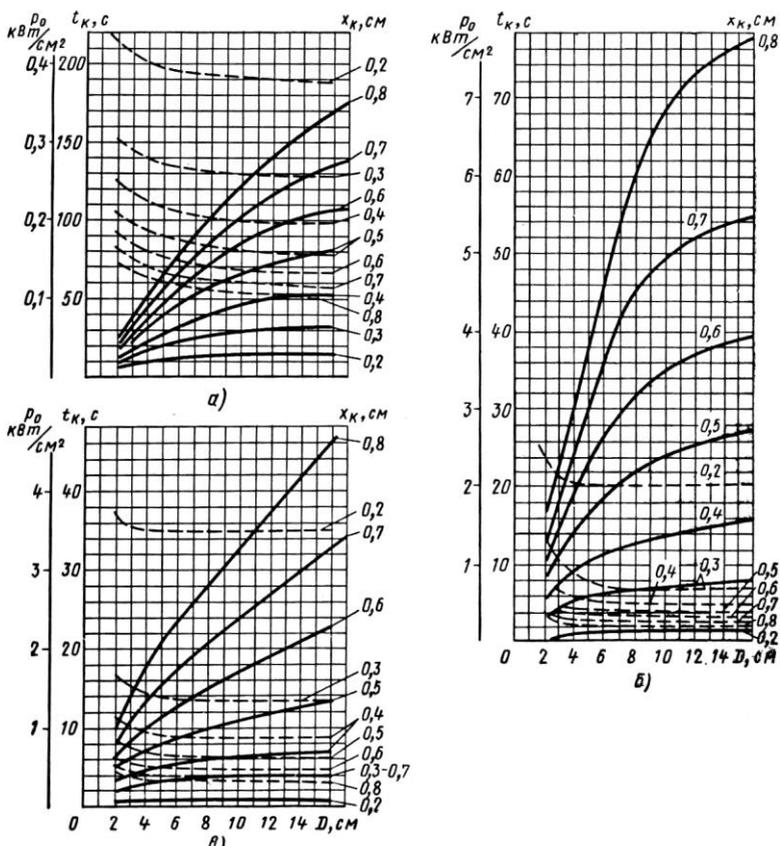
Рис. 6. Зависимости времени нагрева  $t_k$  (сплошные линии) и сообщаемой детали удельной мощности  $p_0$  (штриховые линии) от диаметра  $D$  нагреваемой цилиндрической детали для различных толщин закаленного слоя  $x_k$  при различных частотах: а - 250000 Гц; б = 8000 Гц; в = 2500 Гц
