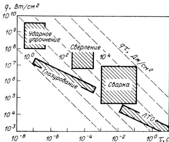
Рисунок 2 - Классификационная диаграмма различных видов лазерной технологии по энергетически-временным параметрам:  $q$  - плотность мощности;  $\tau$  - длительность воздействия
