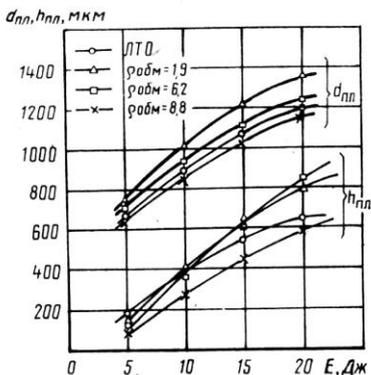
Рис. 6б. Влияние энергии импульса на диаметр  $d_{пл}$  и толщину  $h_{пл}$  зоны плавления при легировании бором стали 40X для различного количества обмазки  $\rho_{обм}$  (мг/см<sup>2</sup>),  $\Delta F = 0$
