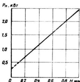
Рис. 62. Зависимость мощности импульса, обеспечивающей эффект приобжата обмазки, от толщины шликерного слоя
