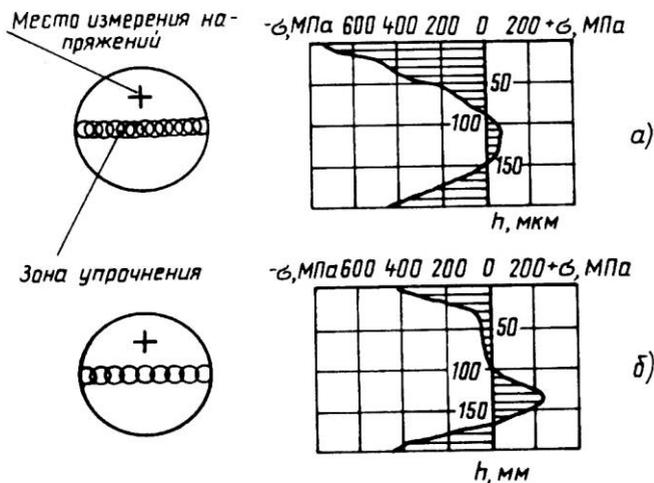
Рис. 63. Распределение остаточных напряжений в поверхностном слое стали 40X, упрочненной лазерным излучением: а - ЛТО с оплавлением, обработка в линию с наложением зон упрочнения,  $K_z = 0,6$ ; б - ЛХТО, обработка в линию с наложением зон упрочнения,  $K_z = 0,3$  (борирование)
