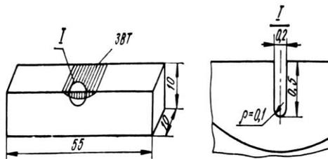
Рис. 19. Схема изготовления образцов для испытаний материалов на трещиностойкость после плазменного упрочнения.
