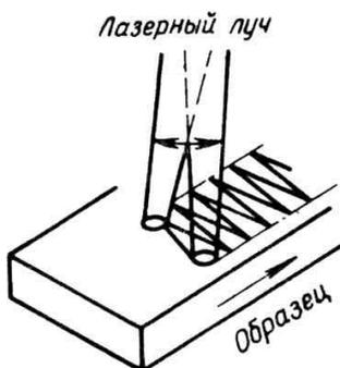
Рис. 56. Схема упрочнения поверхности со сканированием излучением
