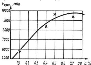
Рис. 68. Зависимость твердости зоны лазерного легирования стали (13% хрома) от содержания углерода (импульсный лазер,  $E = 10Дж$ )
