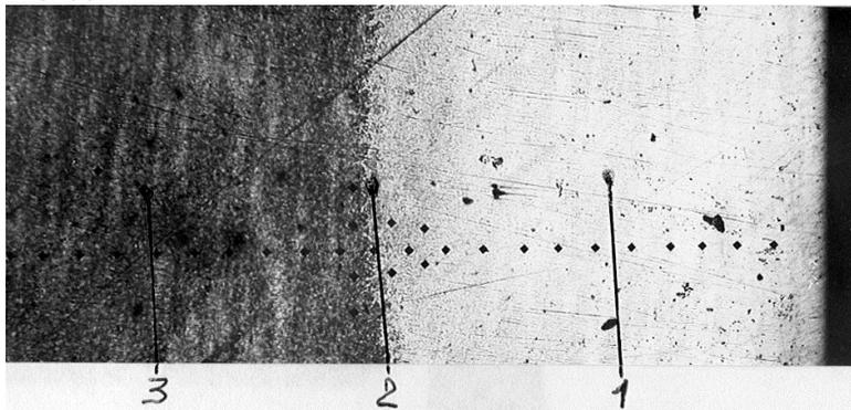
Рисунок 4 - Микроструктура упрочненного слоя на стали 40X после индукционного нагрева (поперечный шлиф): 1 – исходный металл; 2 – переходная зона; 3 – упрочненный слой (x60)
