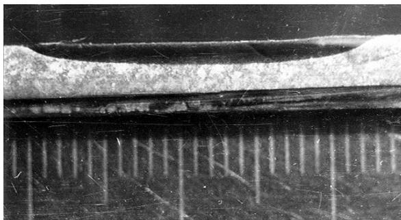
Рисунок 3 - Макроструктура плазменно-упрочненного слоя на стали 65
