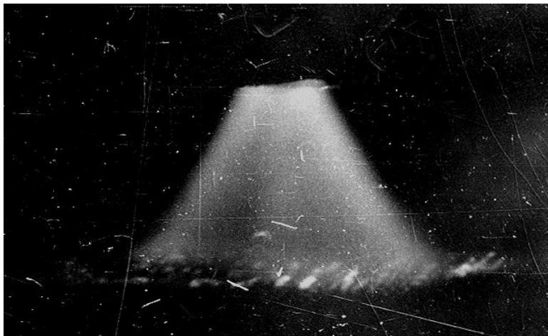
Рисунок 1 - Вид сканируемой плазменной дуги
