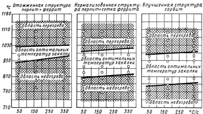
Рисунок 3 - Зависимость интервала оптимальных температур закалки стали 50 от скорости нагрева и исходной структуры
