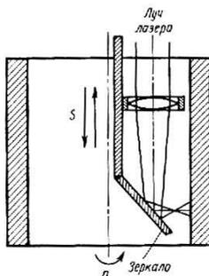
Рис. 54. Схема упрочнения внутренней цилиндрической поверхности
