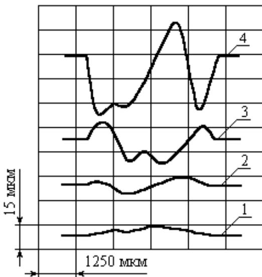
Изменением режимов облучения можно добиться получения требуемой микрогеометрии облученной поверхности, то есть проводить лазерную закалку без нарушения исходной микрогеометрии, либо с заданной степенью нарушения за счет локального оплавления поверхности (рисунки 9). Последний вариант применим
