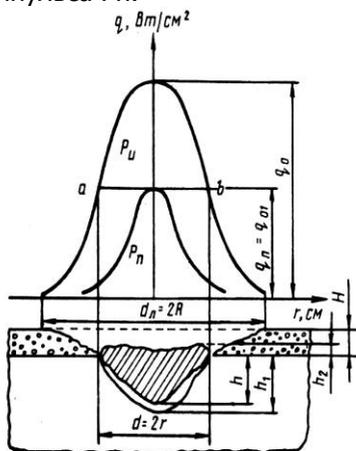
Рис. 60. Принципиальная схема воздействия лазерного излучения с поверхностью металла, покрытой слоем обложки:
