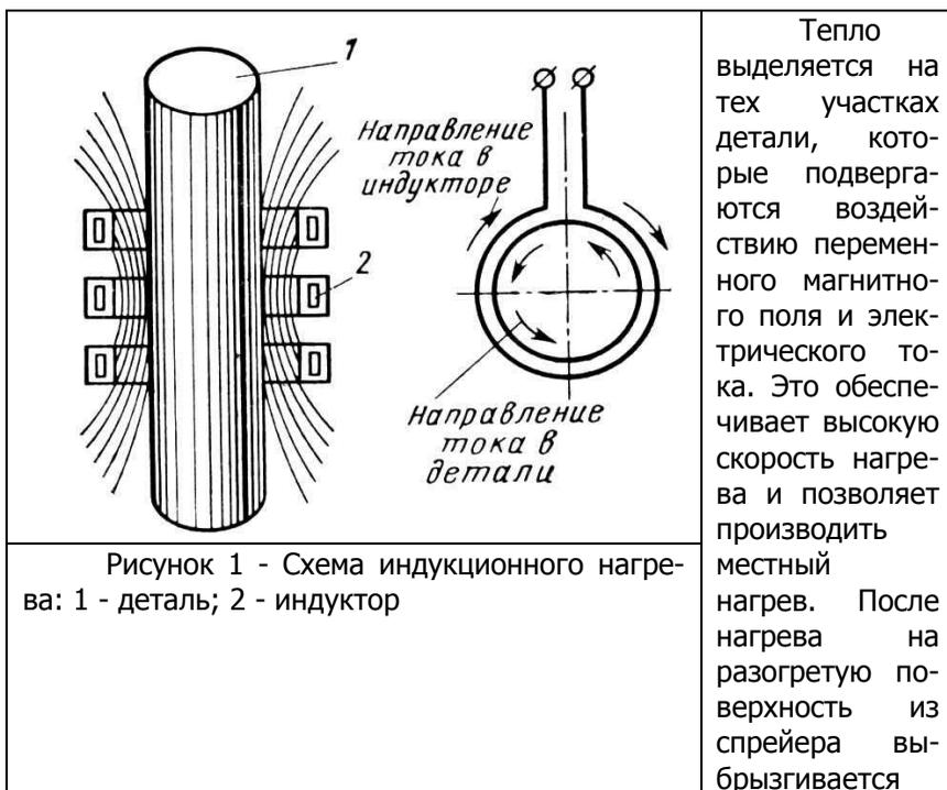
закалочная жидкость (спрейером может служить сам индуктор в виде полый трубки с отверстиями).
