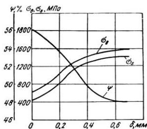
Рис. 18. Изменение механических характеристик по глубине упрочненного слоя:
