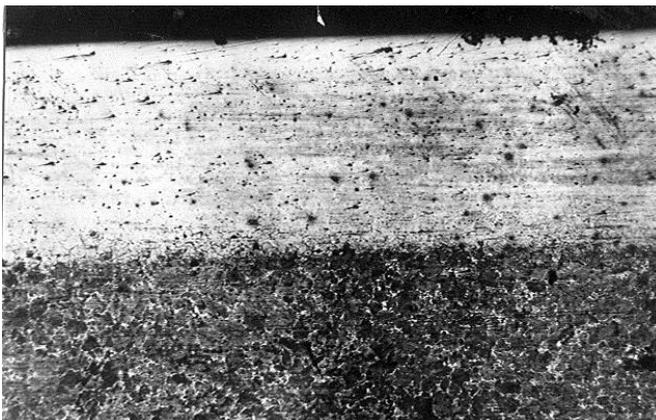
Рисунок 4 - Микроструктура упрочненного слоя на стали 65 после плазменной закалки (x50)
