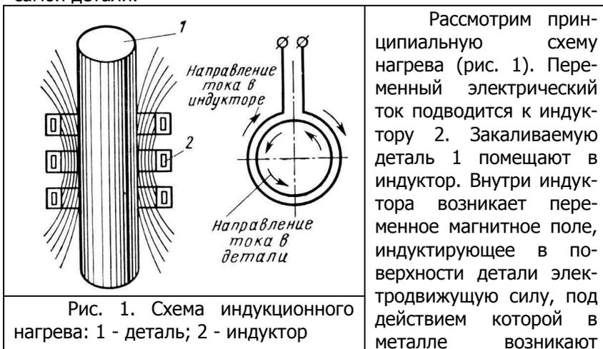
электрические вихревые токи (токи Фуко), вызывающие нагрев детали до высокой температуры. Тепло выделяется на тех участках детали, которые подвергаются воз
