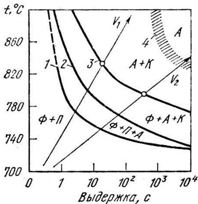
Рис. 11. Диаграмма изотермического образования аустенита в доэвтектоидной стали с 0,45% С при исходной феррито-перлитной структуре
