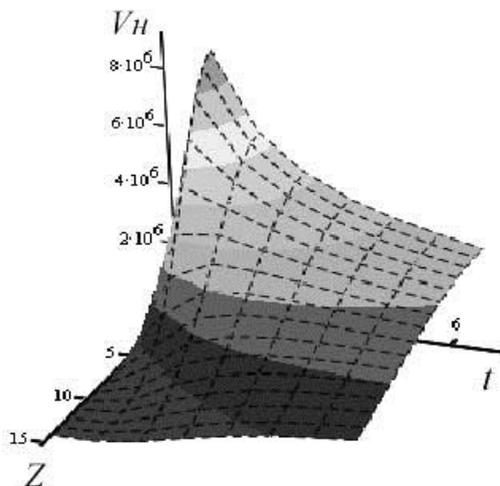
Рис.2 Пример графического вида результата расчета скорости нагрева материала по глубине ( $Z$ ) и времени ( $t$ )
