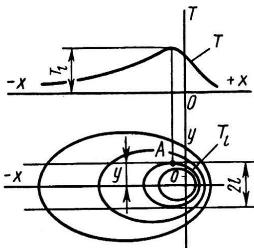
Рис. 27. Ширина зоны  $2l_1$ , нагревающейся выше температуры  $T_1$
