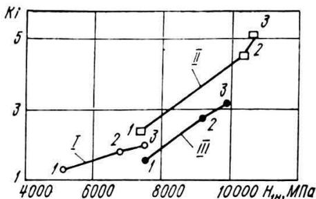
Рис. 17. Изменение коэффициента износостойкости в зависимости от микротвердости после упрочнения: 1 — наплавленный металл 30ХГСА; II — сталь 9ХФ; III — сталь 150ХНМ; 1 — объемная закалка; 2 — плазменное упрочнение с перекрытием ЗТВ на 30%; 3 — плазменное упрочнение без перекрытий
