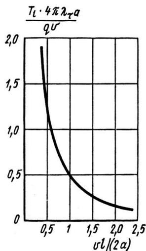
Рис. 28. Номограмма для определения ширины зоны нагрева при движущемся по поверхности полубесконечного тела точечном источнике теплоты
