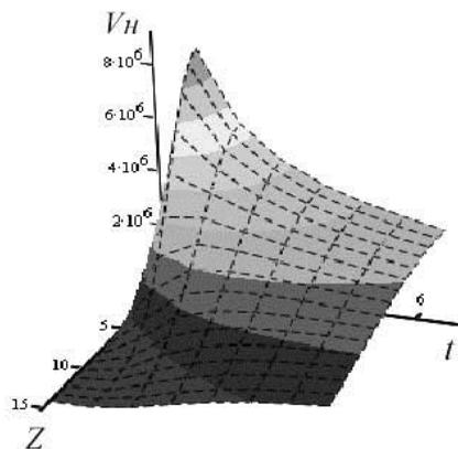
Рисунок 2 - Пример графического вида результата расчета скорости нагрева материала по глубине ( $Z$ ) и времени ( $t$ )
