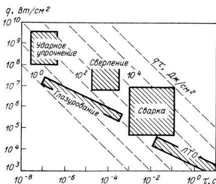
Рис. 23. Классификационная диаграмма различных видов лазерной технологии по энергетическим параметрам:  $q$  - плотность мощности;  $\tau$  - длительность воздействия
