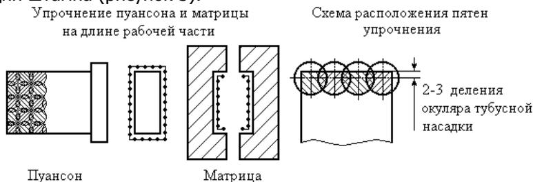
Рисунок 3 - Схема упрочнения вырубного штампа
