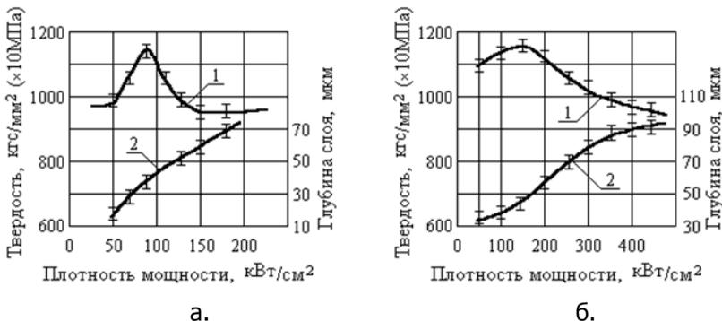
Рисунок 8 - Зависимость средней твердости (1) и глубины (2) упрочненных зон от плотности мощности лазерного излучения: а -  $\tau_{\text{имп}}=1$  мс; б -  $\tau_{\text{имп}}=3-6$  мс
