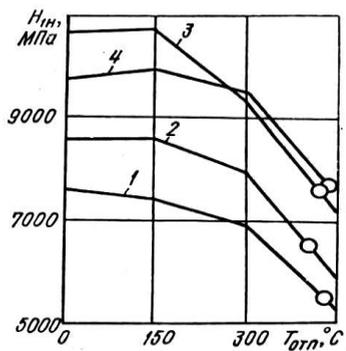
Рис. 21. Зависимость микротвердости закаленной зоны от температуры последующего отпуска: 1— сталь 20ХГСА; 2 — сталь 45; 3 — сталь 9ХФ, 4 — сталь 150ХНМ; о — микротвердость после объемной закалки
