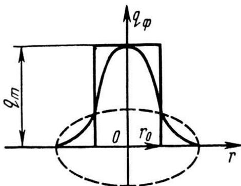
Рис. 26. Нормальное распределение плотности потока в радиальном направлении
