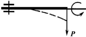
Рис.35. Схема консольного нагружения образца при испытаниях на усталость
