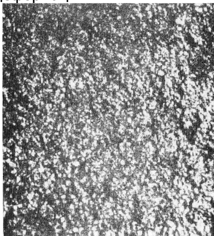
Рис.3. Камневидный квазихрупкий излом стали
