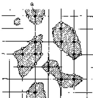
Рис. 23 - Схема определения относительной удельной поверхности методом случайных секущих в комбинации с точечным методом.
