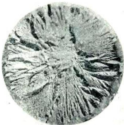
Рис. 17. Излом «звездочкой» разрывного цилиндрического образца из стали 30ХГСА после закалки и отпуска при  $570^\circ$ . х 7.
