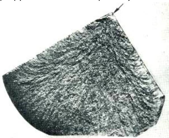
Рис. 11. Хрупкий излом детали из стали 30ХГСА, возникший в эксплуатации
