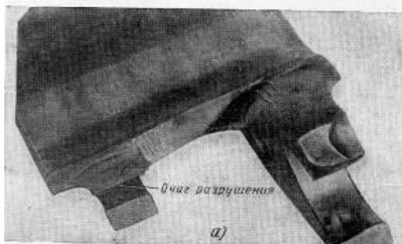
Рис. 35. Поверхность разрушения главного шатуна поршневого двигателя
