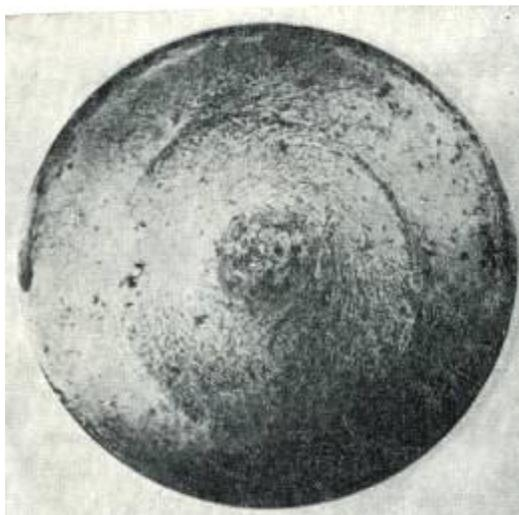
Рис. 19. Излом цилиндрического образца при кручении (сталь 40НМА после закалки и отпуска при 550°),
