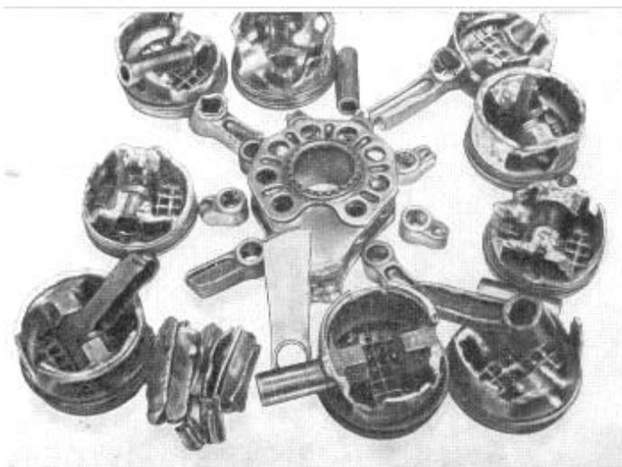
Рис. 43. Общий вид разрушенных деталей авиационного двигателя.
