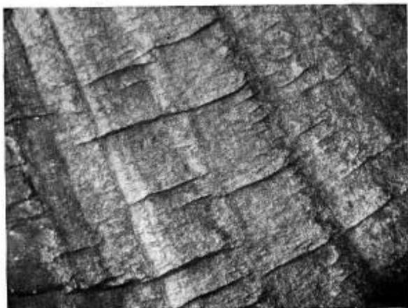
Рис. 41. Участок ускоренного развития излома коленчатого вала,  $\times 20$ .
