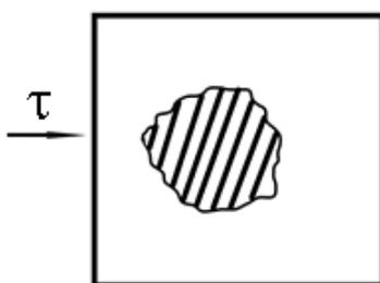
Рисунок 57. Замкнутый контур дислокации.
