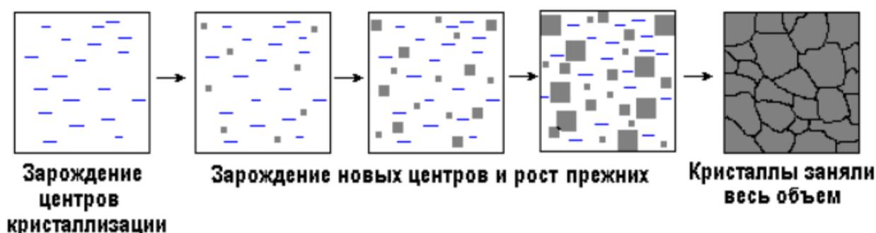
Рисунок 74. Процесс образования кристалла
