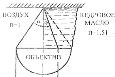
Рис.2.15 Влияние коэффициента преломления среды на ход световых лучей в сухом и иммерсионном объективе
