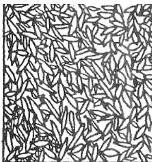
Рис. 2.19. Схема микроструктуры доэвтектоидной стали 45 после полной закалки в воде. Мартенсит. х500
