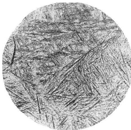
Рис. 46 . Микроструктура быстроохлажденного титанового сплава: игольчатая мартенситная фаза  $\alpha'$ ;  $\times 500$
