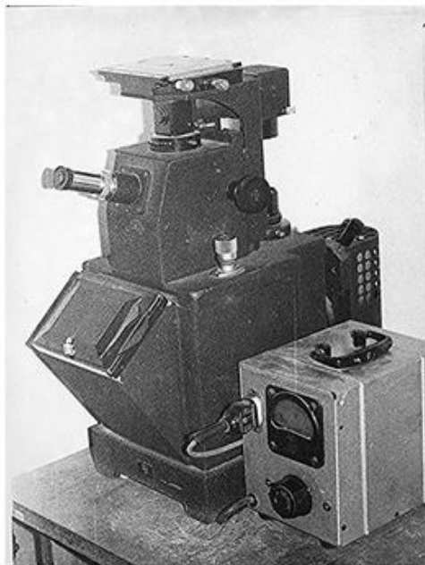
Металлографический исследовательский микроскоп МИМ-7 вертикального типа.
