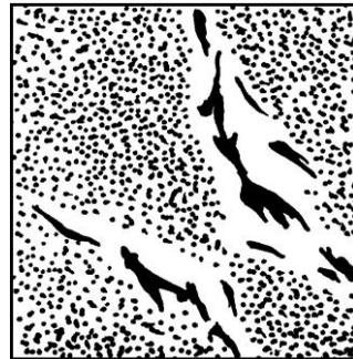
Рисунок 3.- Схема микроструктуры эвтектического белого чугуна. Ледебурит.  $\times 350$
