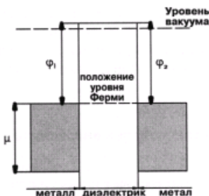
Рис. 4. Энергетические уровни в системе металл – диэлектрик – металл в состоянии равновесия при отсутствии смещения
