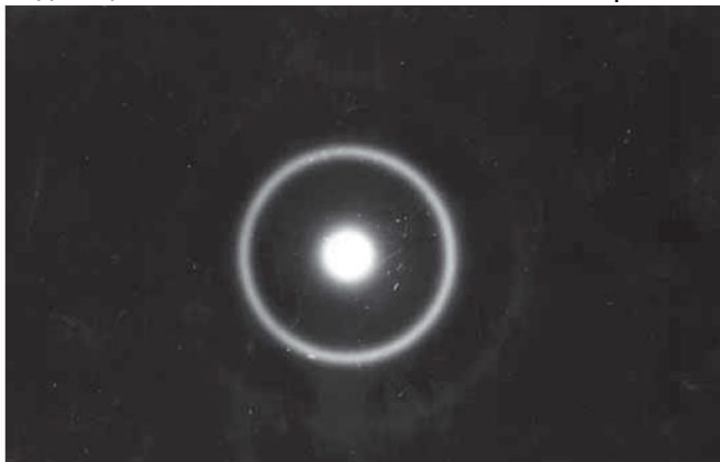
Рисунок 1.5 - Типичный вид электронограммы для аморфного материала
