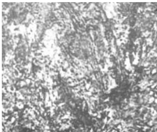
Рис. 3.3. Микроструктура ГДПС на основе порошков Astaloy CrM (а), ПЖР H2M (б), \times 500
