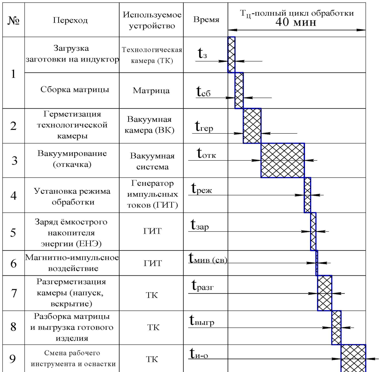
Рис. 23. Технологическая диаграмма процесса.
