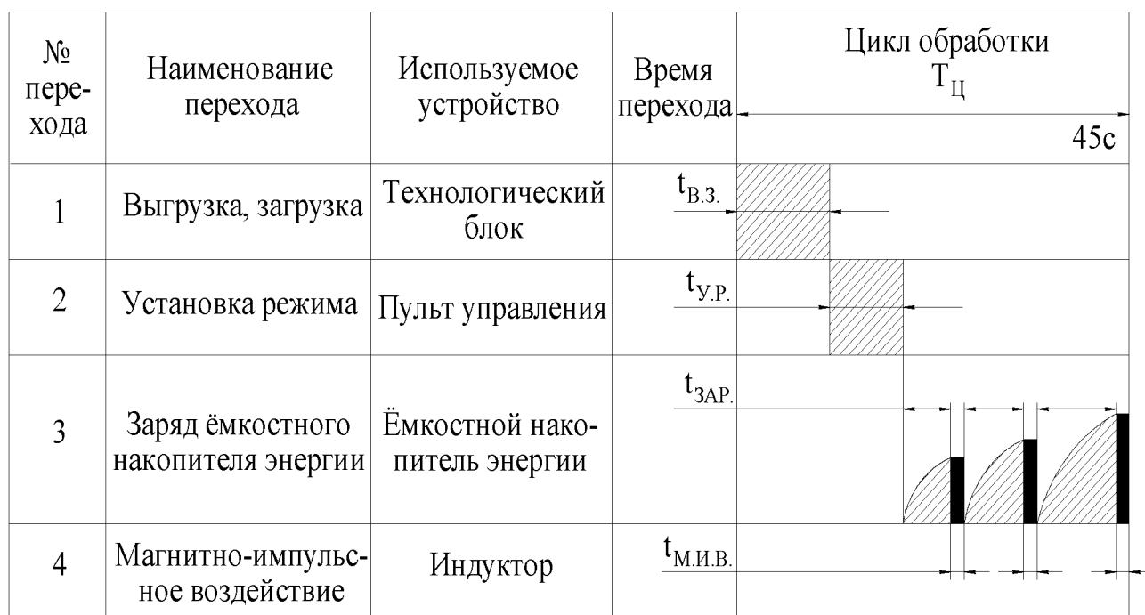
Рис. 65. Циклограмма работы трёхканальной магнитно-импульсной установки
