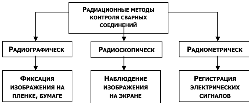
Рис.23. Классификация методов радиационного контроля по типу индикатора
