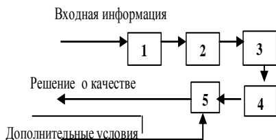
Рис.36. Блок-схема для расшифровки радиографических снимков: 1-считывающее устройство; 2-блок
