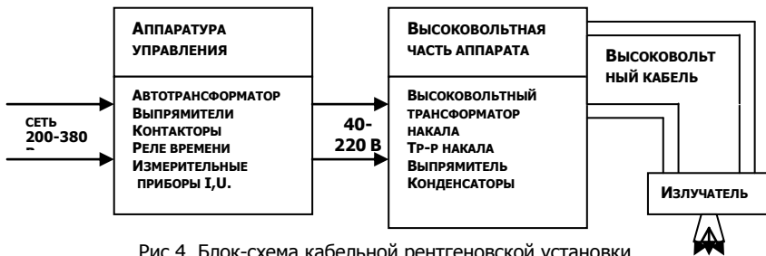
Рис.4. Блок-схема кабельной рентгеновской установки
