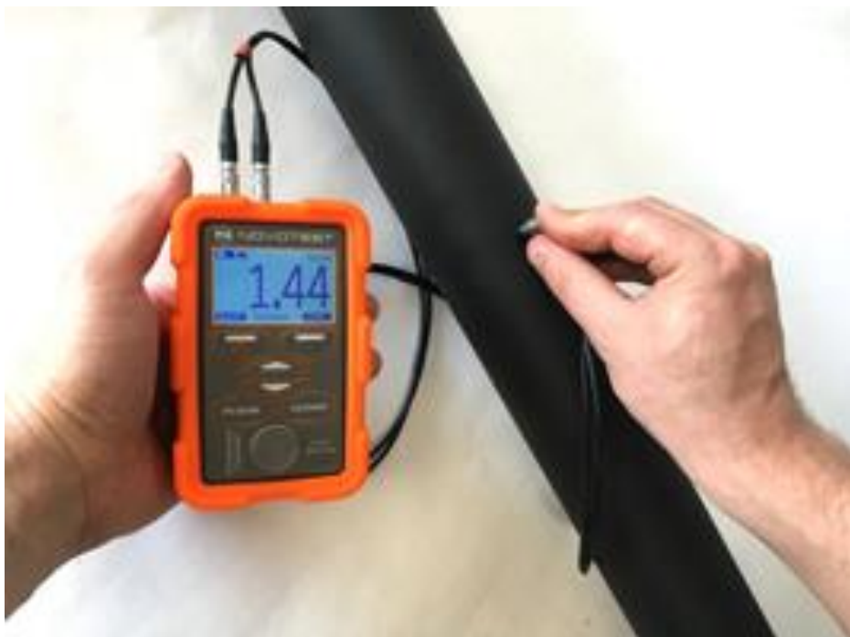
Рис.3 Проведение измерения толщиномером NOVOTEST УТ-1
