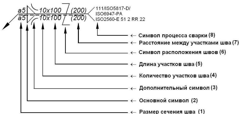
Рис. 3.21. Структура условного обозначения сварных соединений в соответствии с ISO 2553
