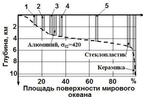
Рис. 2.3. Возможности освоения океанских глубин аппаратами, изготовленными из материалов с различной удельной прочностью: 1 – сталь: \sigma_{02} = 780 МПа, \rho = 7,8 Г/см 3 ; 2 – сталь: \sigma_{02} = 840 МПа, \rho = 7,8 Г/см 3 ; 3 – сталь: \sigma_{02} = 1400 МПа, \rho = 7,8 Г/см 3 ; 4 – титановый сплав: \sigma_{02} = 840 МПа, \rho = 4,5 Г/см 3 ; 5 – титановый сплав: \sigma_{02} = 1050 МПа, \rho = 4,5 Г/см 3 ; пунктирной линией показано распределение глубин мирового океана, а столбиками – возможная глубина погружения глубоководного аппарата в зависимости от типа конструкционного материала и его удельной прочности
