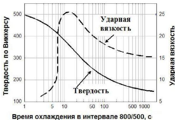
Рис. 2.6. Влияние скорости охлаждения при сварке на механические свойства сварного соединения
