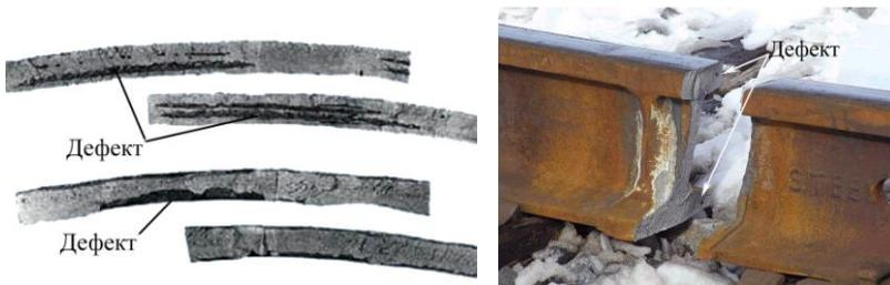
Рис.2.8. Дефекты в шве, не выявленные на стадии изготовления (в стенке трубы и в стыке рельса, выполненного термитной сваркой)
