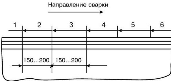
Рис.3.10. Направление сварки всего соединения (стрелка вверху) и сварки отдельных ступеней; 1-6 – последовательность сварки секций
