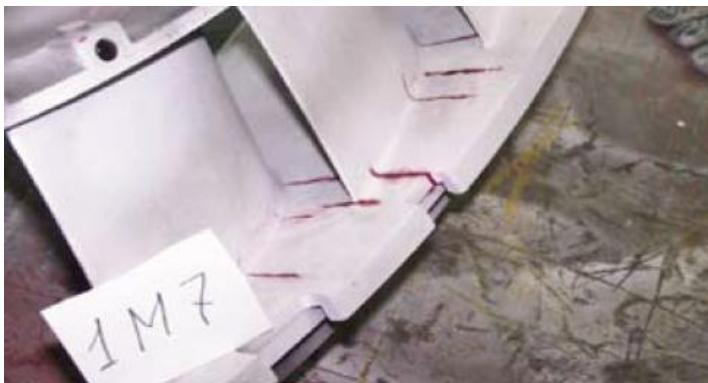
Рис.2.18. Направляющие лопатки газовой турбины ГТК-25-И (множественные трещины термической усталости)
