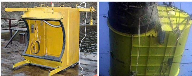
Рис.8.4. Специализированный подводный кессон Захарова (слева); кессон для ремонта опоры буровой платформы (справа)
