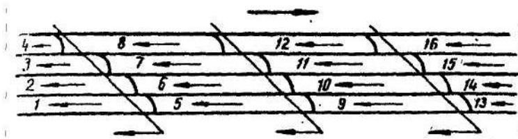
Рис.4.6. Последовательность наложения валиков при ремонте трещин, выходящих на свободную кромку, путём выполнения шва блоками
