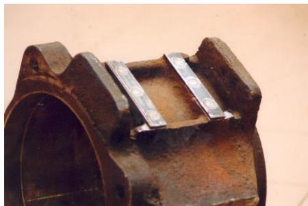
Рис.7.13. Букса грузовых вагонов после ремонта изношенных поверхностей методом ДРД
