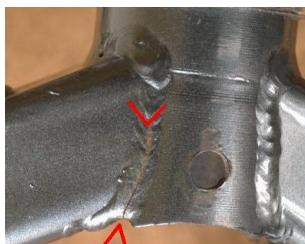
Рис.1.4 Холодные трещины
