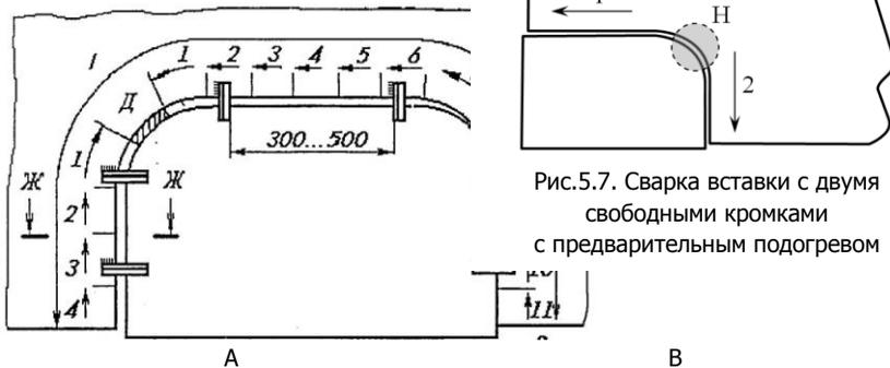
Рис.5.7. Сварка вставки с двумя свободными кромками с предварительным подогревом
