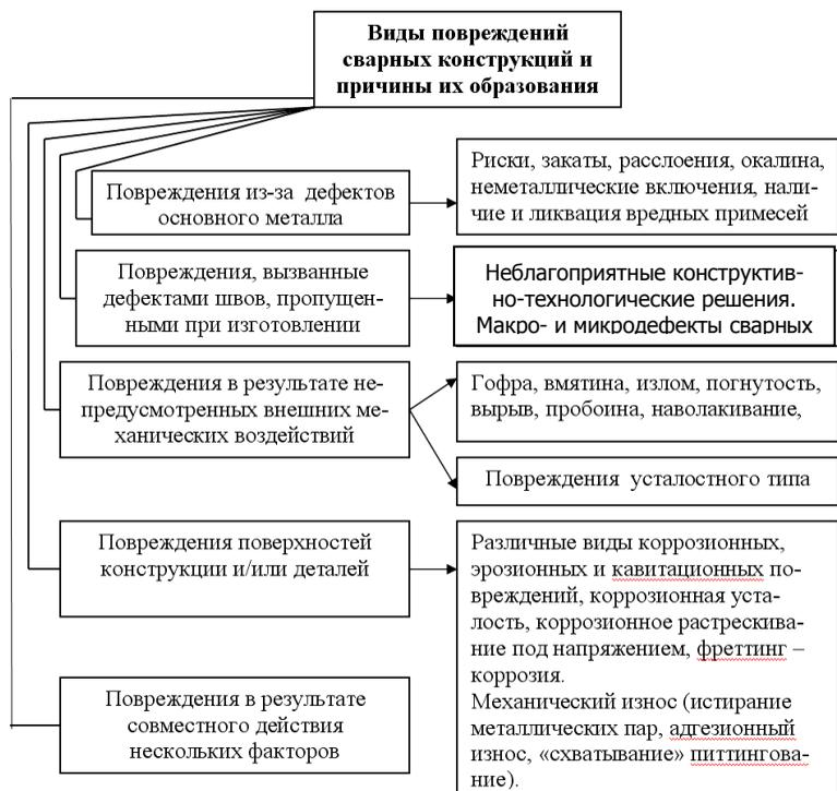
Рис.2.2. Классификация повреждений сварных конструкций
