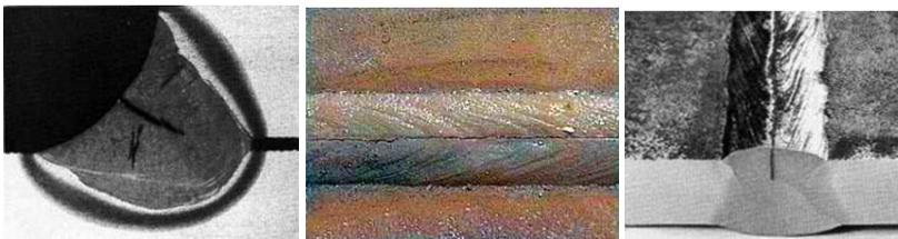
Рис.1.3. Горячие трещины в сварном шве
