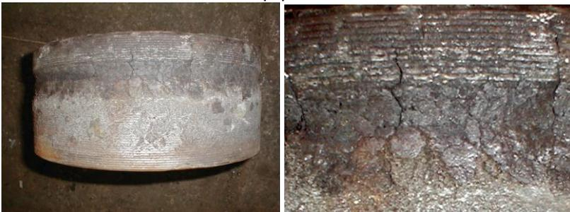
Рис.2.19. Разгарные трещины на поверхности ролика машины для производства минеральной ваты
