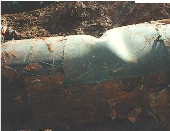
Рис.2.13. Повреждение трубопровода в результате механического воздействия
