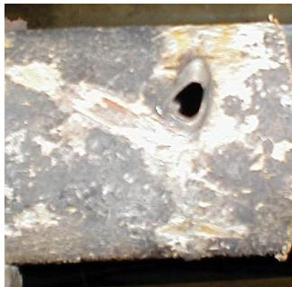
Рис.2.14. Эрозионное повреждение газопровода в зоне контакта с электрическим проводом
