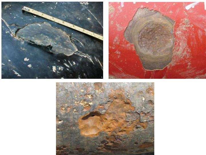
Рис.6.1. Примеры коррозии стенки трубопроводов
