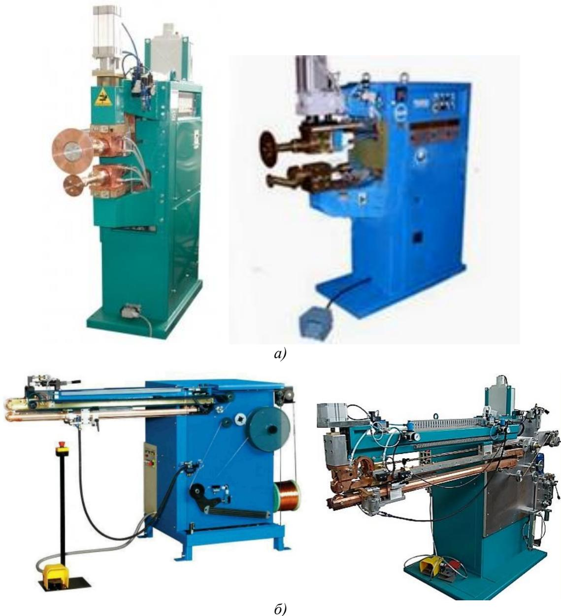
Рис. 2.9. Машины для холодной шовной сварки (относительно длины свариваемых деталей):
