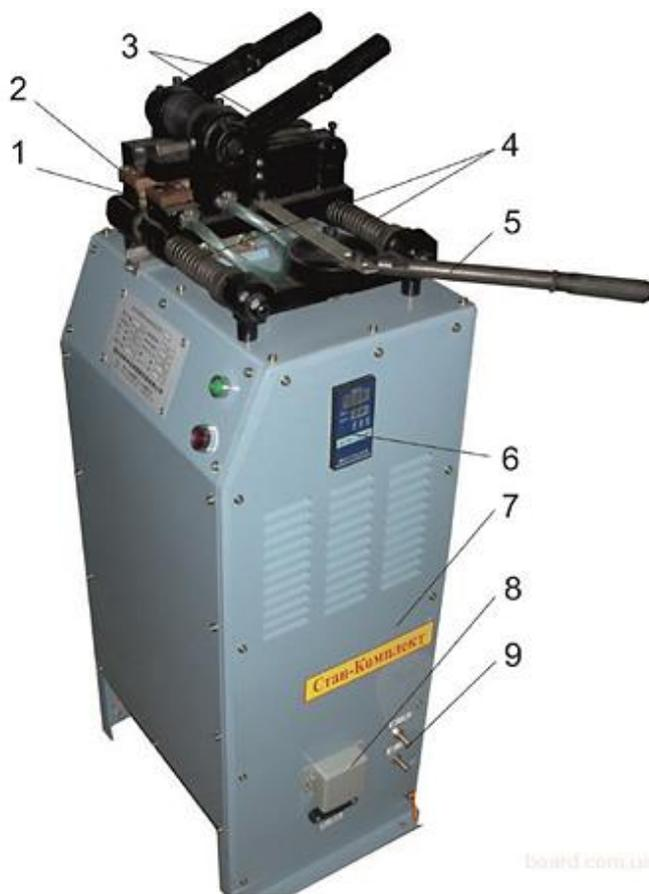
Рис. 6.2. Машина для стыковой сварки сопротивлением с ручным приводом осадки: 1 – суппорт неподвижный; 2 – свариваемые детали; 3 – устройства зажимные; 4 – направляющие; 5 – рычаг привода осадки; 6 – выключатель сетевого напряжения; 7 – корпус машины; 8 – коробка подвода сетевого напряжения; 9 – подключение подачи и слива охлаждающей жидкости
