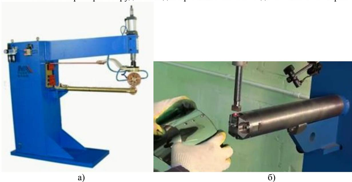
Рис. 2.2. Установки холодной сварки Трех - YouTube: а – шовная сварка; б – точечная сварка
