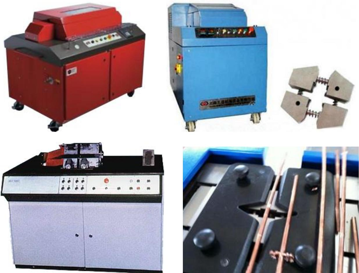
Рис. 2.1. Примеры оборудования для промышленной холодной стыковой сварки
