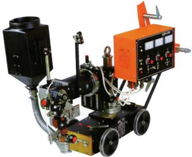
Рис. 8.33. Сварочный трактор АДФ-1250
