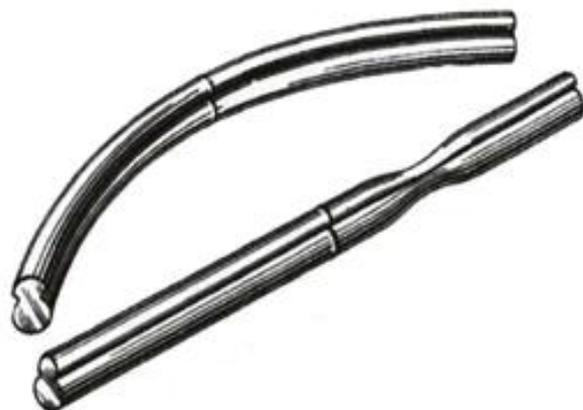
Рис. 2.14. Медный контактный провод после испытания на растяжение и изгиб
