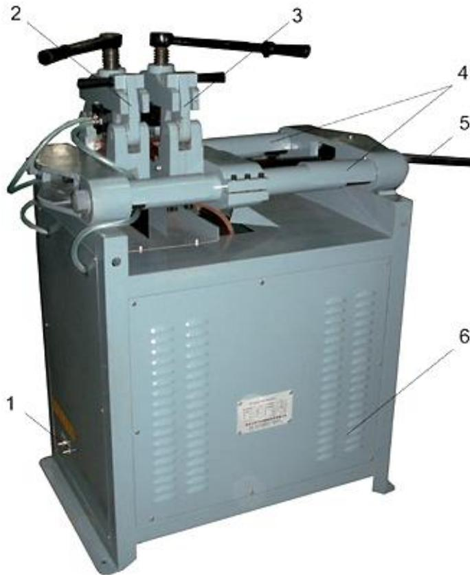
Рис. 6.3 Машина для стыковой сварки сопротивлением с гидравлическим приводом осадки: 1 – подключение подачи (слева) и слива (справа) охлаждающей жидкости; 2 – суппорт неподвижный; 3 – суппорт подвижный; 4 – направляющие подвижного суппорта; 5 – ручка подвода (отвода) подвижного суппорта; 6 – корпус
