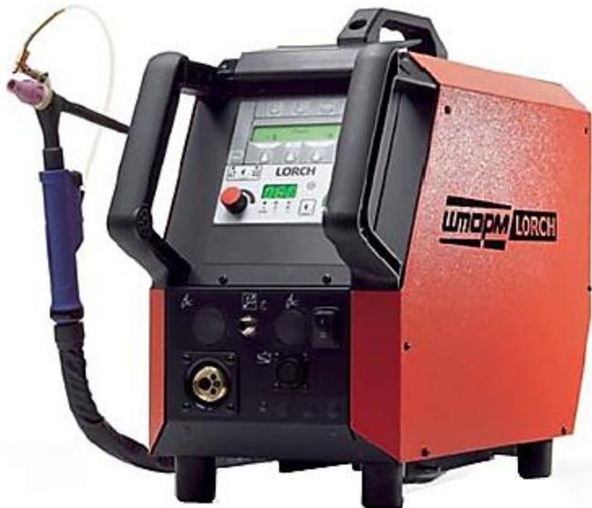
Рис. 8.24. Блок подачи присадочной проволоки Feed
