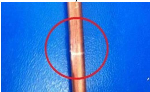
5) Удалить облой образовавшийся в процессе холодной сварки
