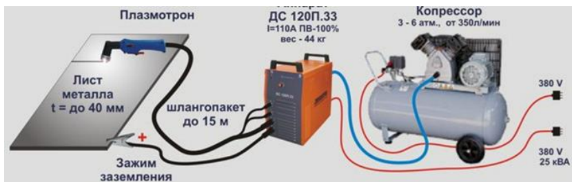
Рис. 2.36. Схема подключения плазматрона
