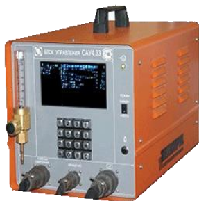
Рис. 2.34. Микропроцессорный блок управления DC CAУ4.33 с дисплеем управления
