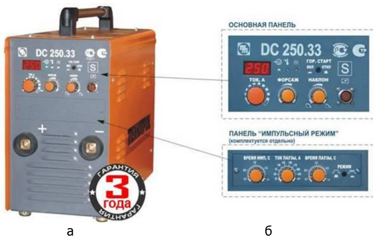
Рис. 2.27. Выпрямитель DC 250.33: а – общий вид; б – панели управления
