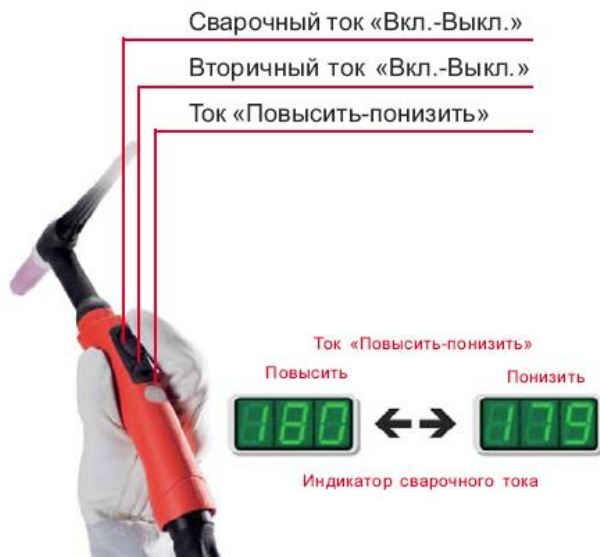
Рис. 2.17. Горелка с дистанционным управлением
