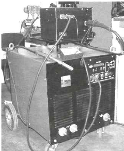
Рис. 2. 10. Тиристорный выпрямитель ВДУ-516 с механизмом подачи
