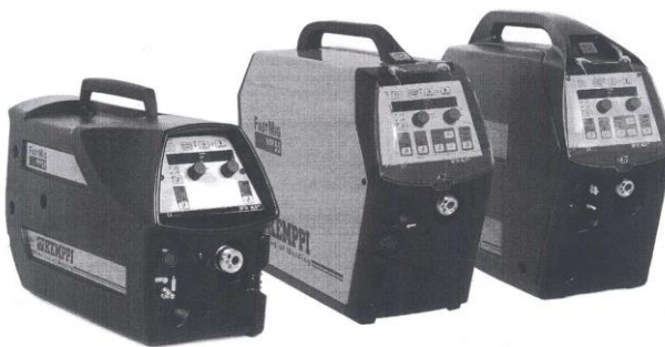
Рис.4.23. Источники питания Fastmigtм KMS 300, 400 и 500 – а, проволокоподающие устройством Fastmigtм MSF 53, MFS 55 и MSF 57 – б
