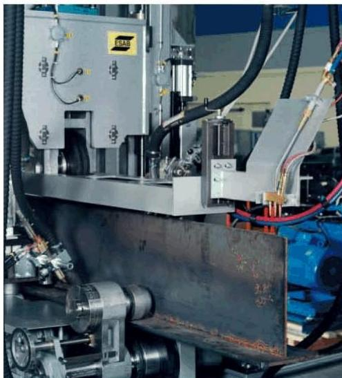
Рис. 4.10. Машина для сварки балок таврового профиля
