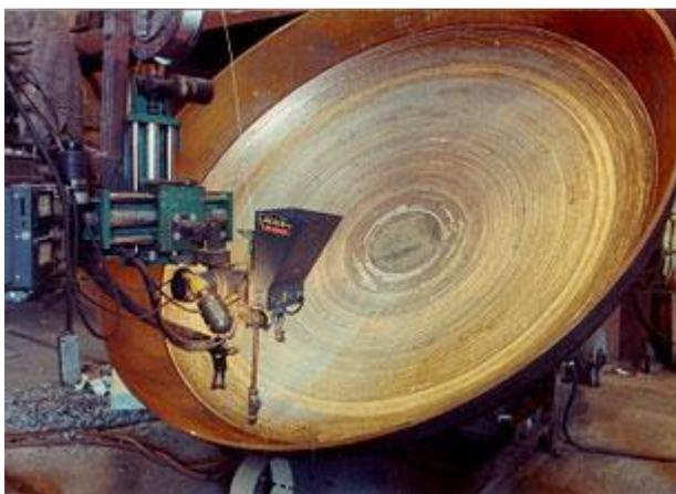
Рис. 3.23. Установка для наплавки внутренней поверхности днища
