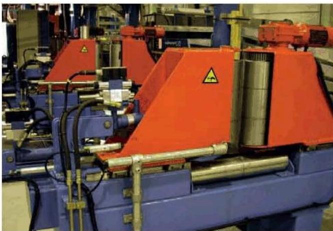
Рис. 4.9. Входной (подающий) конвейер.
