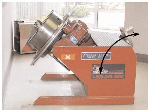
Рис. 3.21. Внешний вид позиционера с наклонной планшайбой.
