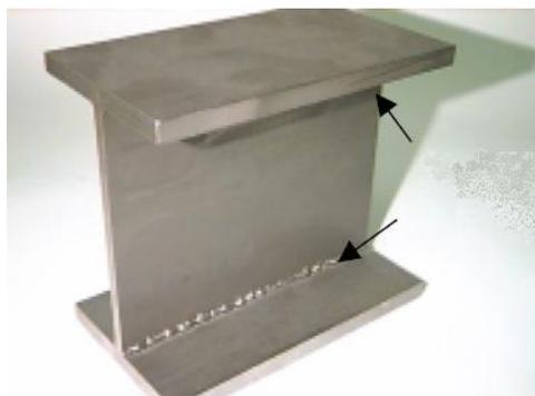
Рис 4.16. Внешний вид сварной (ТВЧ) балки.
