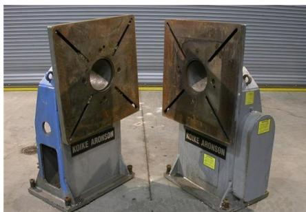
Рис 3.20. Сварочная установка с горизонтальным вращателем и стойки двухстоечного вращателя
