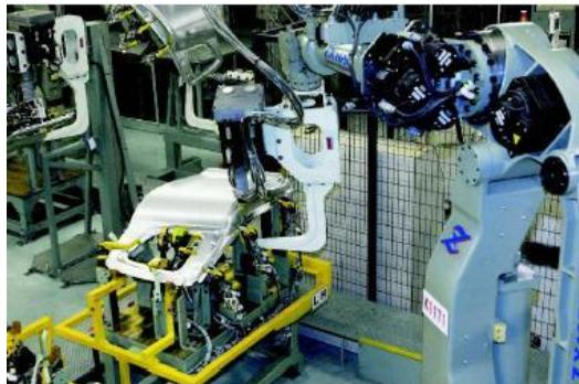
Рис. 9.28. Точечная сварка двери автомобиля Mazda RX8.
