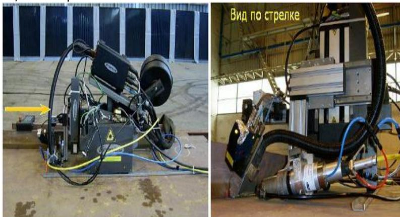
Рис. 9.16. Лазерная гибридная сварка по типу сварочного трактора. (Конструкция SLV Mecklenburg-Vorpommern GmbH, г.Росток, Германия)
