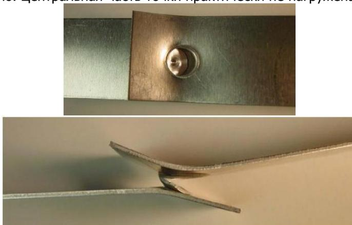
Рис. 9.27. Разрушение образца сварного точечного соединения.
