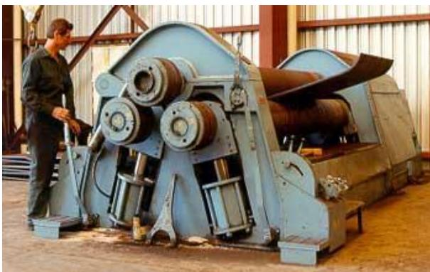
Рис.3.10. Схема вальцовки обечаек и внешний вид трехвалковых вальцов:
