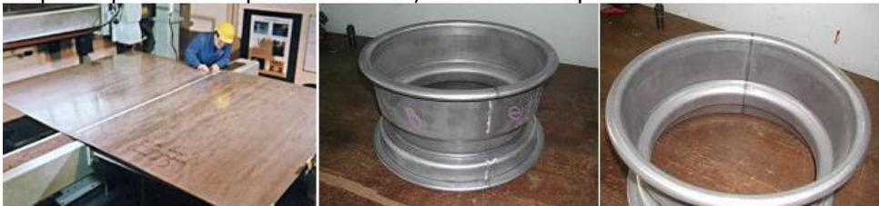
Рис. 9.25. Примеры сварных конструкций, выполненных сваркой трением с перемешиванием.
