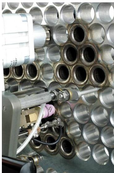
Рис. 7.24.Автомат для орбитальной сварки.
