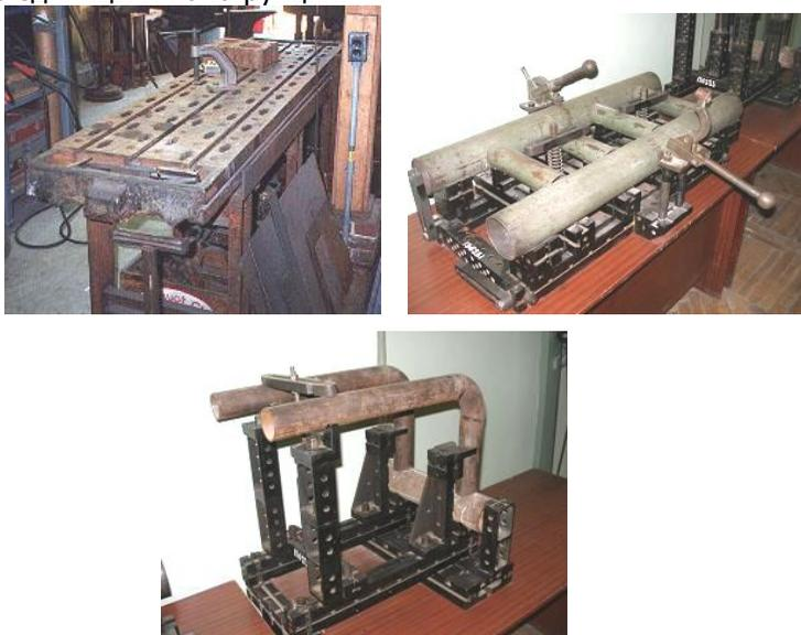
Рис. 3.29. Сборочное приспособление на основе комплекта унифицированных деталей УСПС
