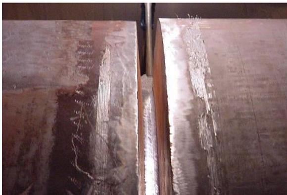
Рис. 7.18. Сварка стыка обечайки с узкой ( $1^\circ \dots 2^\circ$ ) разделкой
