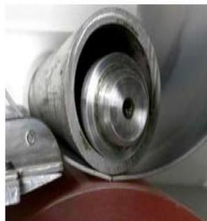
Рис. 7.4. Схема гибки тонкостенных обечаек на двухвалковых машинах.
