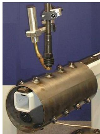
Рис. 7.8. Приварка арматуры к обечайке
