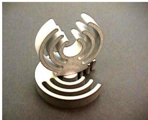
Рис. 3.7. Примеры деталей, контур которых получен методом гидроабразивной резки
