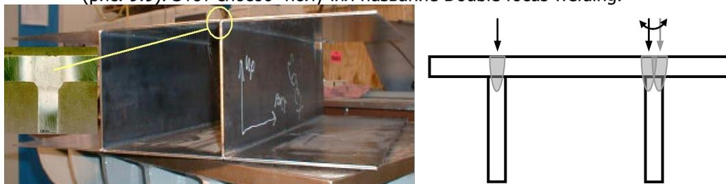
Рис. 9.9. Лазерная сварка таврового соединения путем проплавления поясного листа
