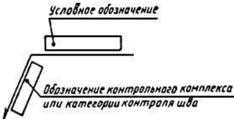
Рис. 8 Место обозначения контрольного комплекса шва
