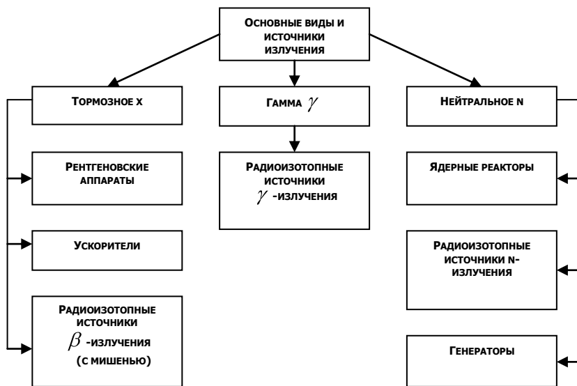
Рис.4. Классификация основных источников ионизирующих излучений
