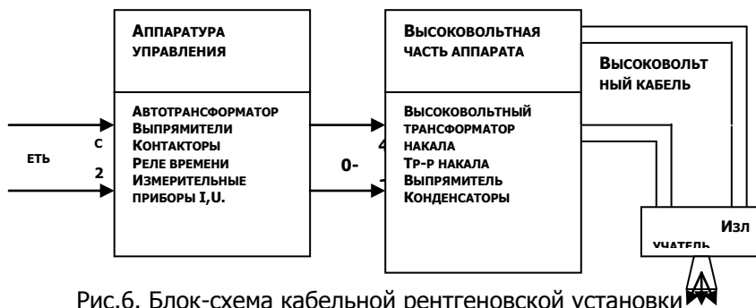
Рис.6. Блок-схема кабельной рентгеновской установки
