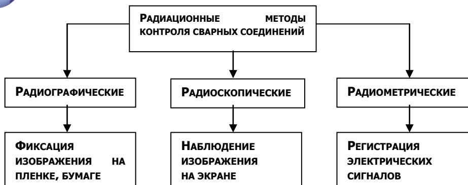
Рис.26. Классификация методов радиационного контроля по типу индикатора
