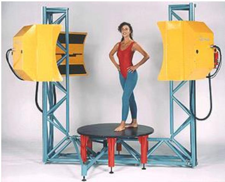
Рисунок 6.1 – Автоматическая установка 3D боди-сканирования WB4
