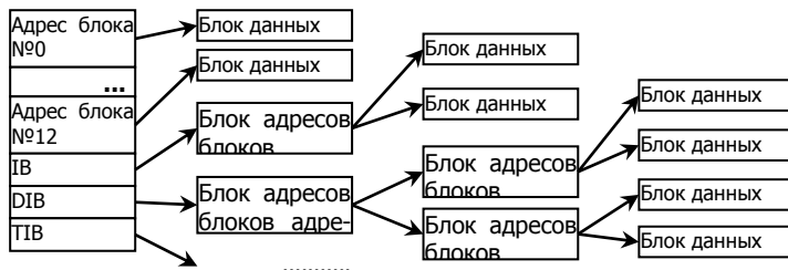
Рисунок 3 – Описание размещения файлов в ФС ext2fs
