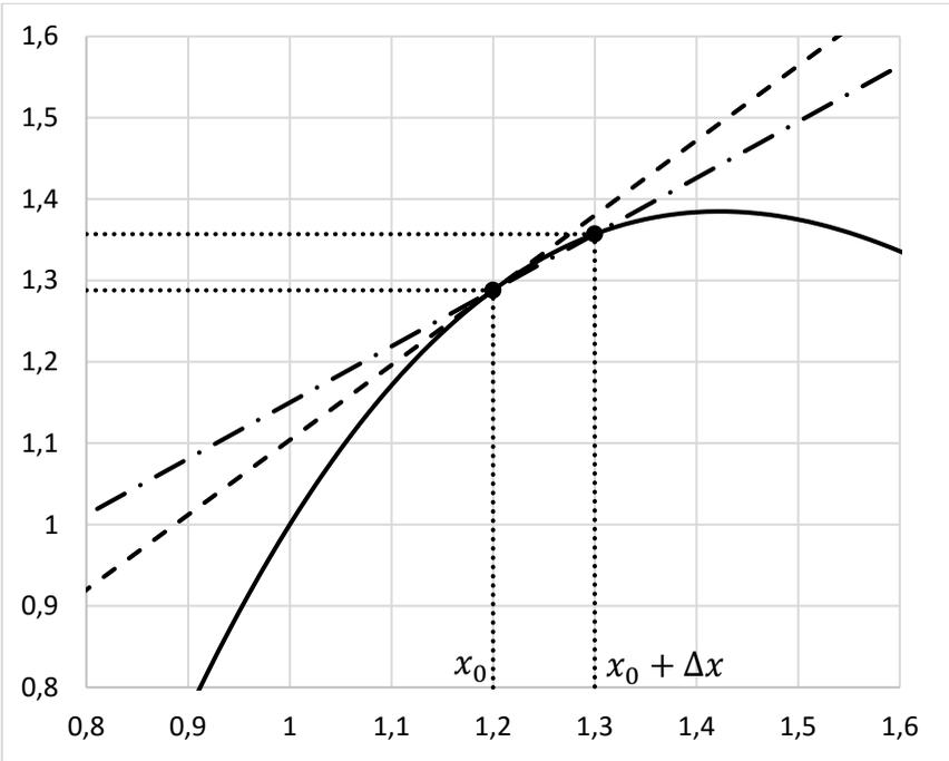
Рисунок 1. Вычисление производной с помощью восходящей конечной разности.
