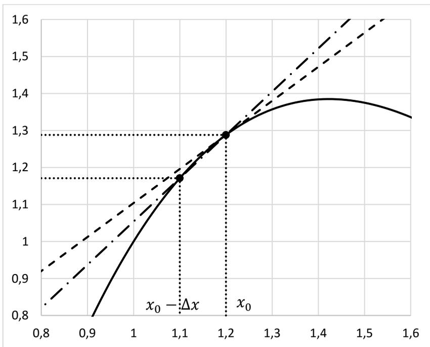
Рисунок 2. Вычисление производной с помощью нисходящей конечной разности.
