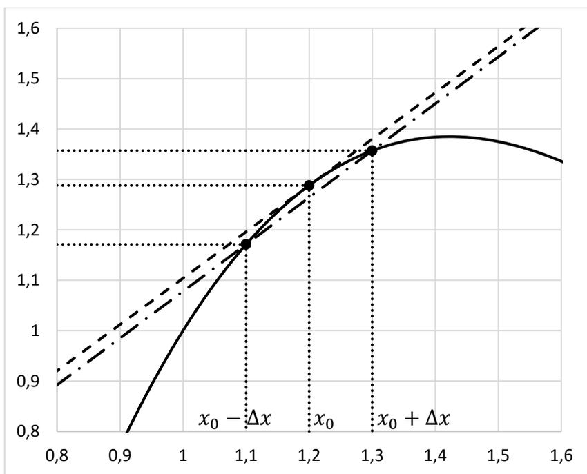
Рисунок 3. Вычисление производной с помощью центральной конечной разности.
