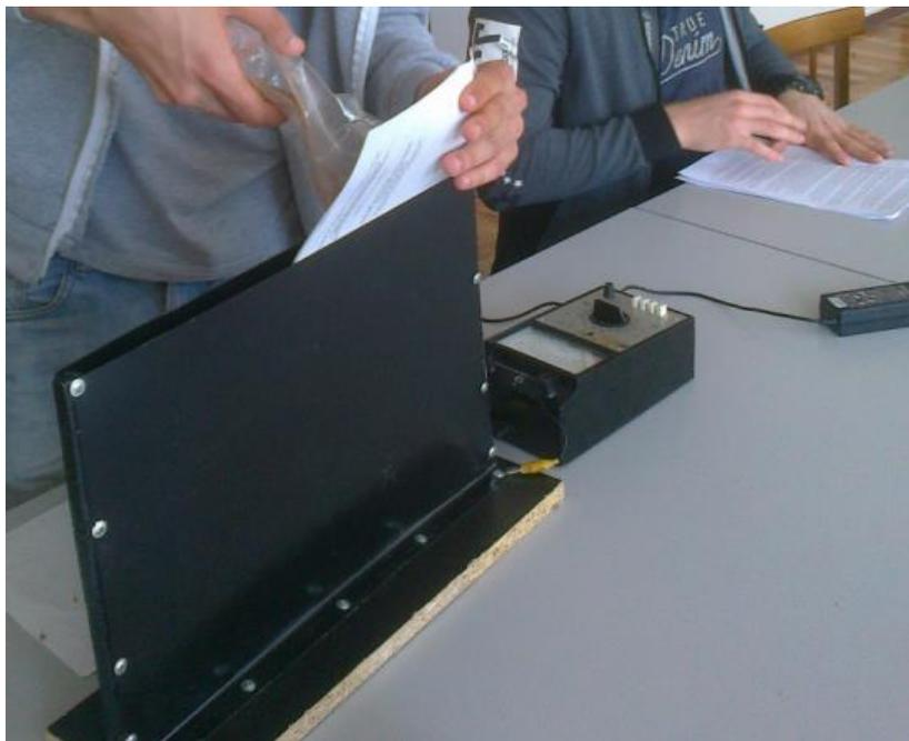
Рисунок 9.1 – Процесс измерения диэлектрической проницаемости зерна
