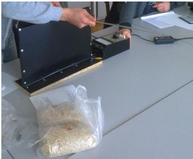
Рисунок 9.2 – Влияние деформации измерительной ячейки на результат при определении диэлектрической проницаемости.
