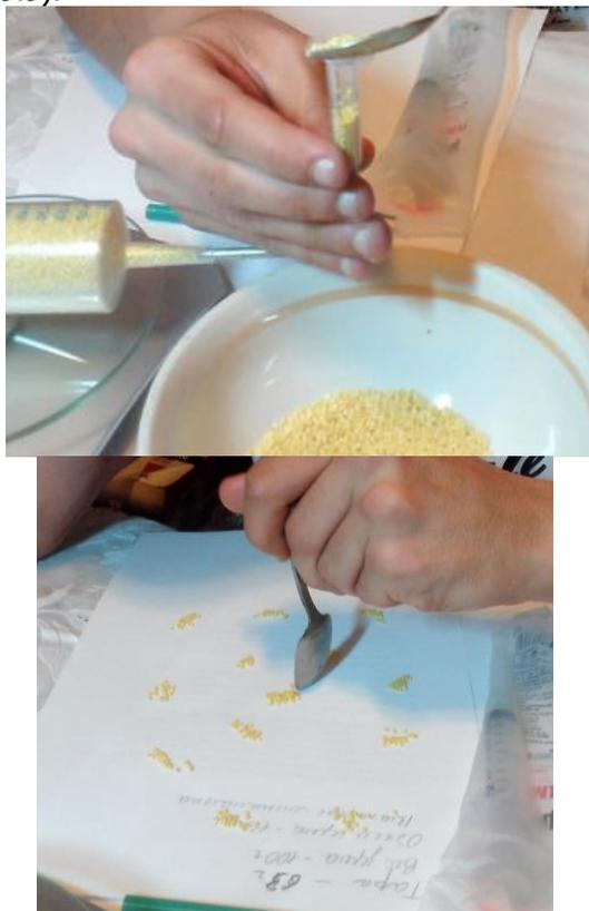
Рисунок 9.9 – Измерение массы зерновки пшена: a – объема; b – числа зерен
