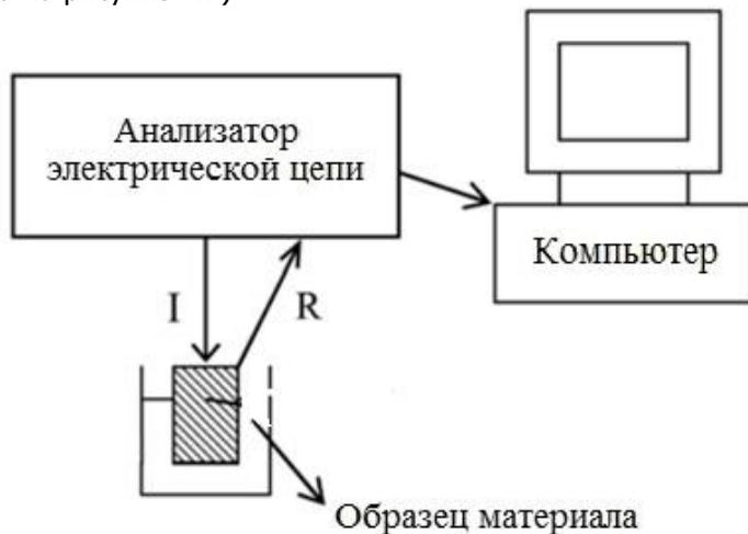
Рисунок 7.6 - Схематическая реализация коаксиального метода. Обозначения идентичны обозначениям рисунка 7.4
