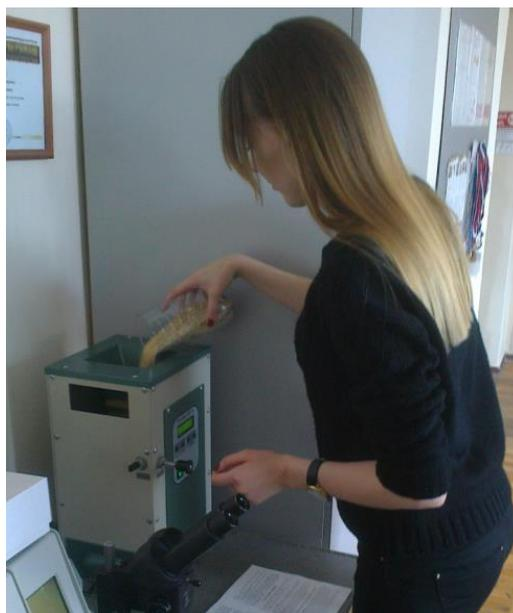
Рисунок 9.3 – Измерение влажности зерна с помощью прибора
