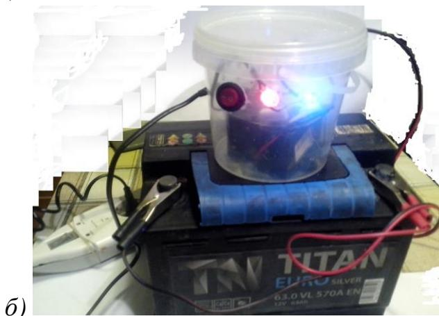
Рисунок 6.7. Вид зарядного устройства, разработанного авторами с использованием системы Electronics Workbench: *а* – элементы электрической схемы; *б* – работа макета устройства по схеме (рисунок 6.6).
