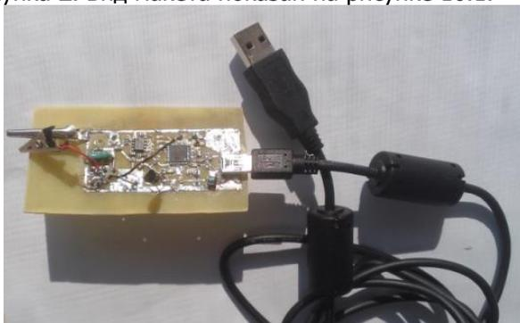
Рисунок 10.1 – Высокочастотный электроизмерительный модуль для определения диэлектрической проницаемости зерна в полевых условиях.
