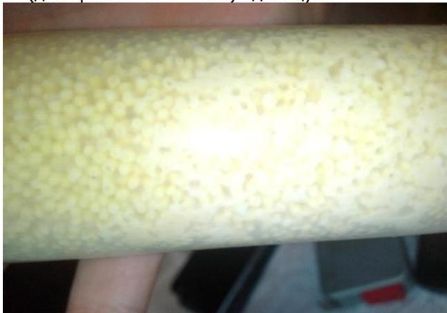
Рисунок 9.14 – Деформация и уплотнение влажного (20 %) пшена
