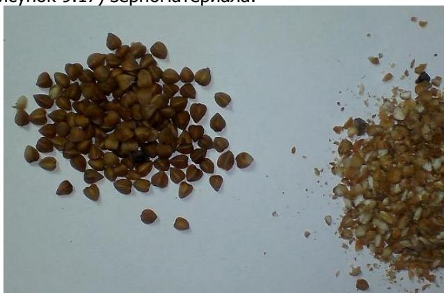
Рисунок 9.17 – Образец исходного и измельченного зерноматериала (гречиха)
