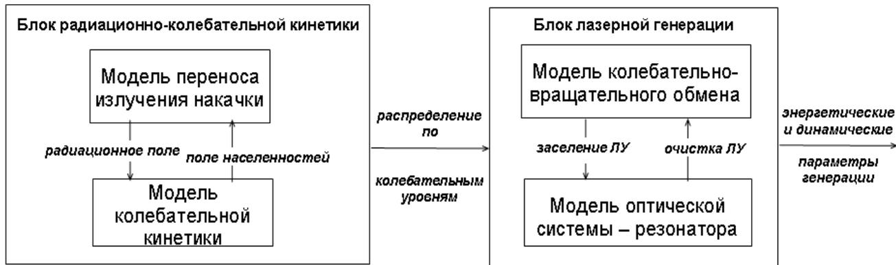
Рисунок 12.51 – Схема фрагментации ИММ СО<sub>2</sub>-лазера с накачкой тепловым излучением. ЛУ – аббревиатура термина “лазерный (колебательно-вращательный) уровень”
