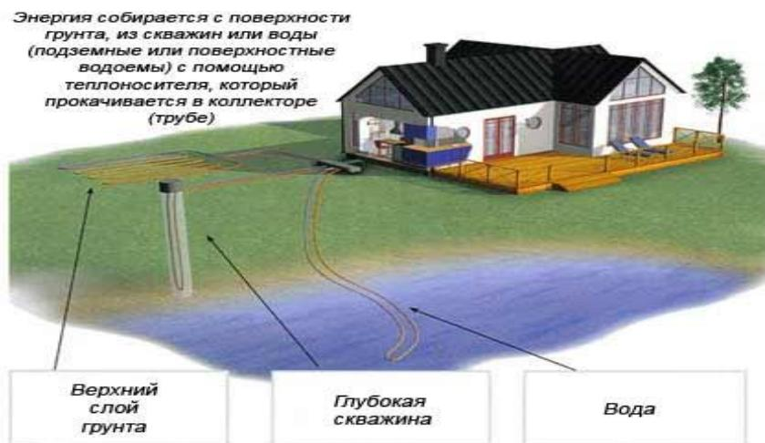
Рисунок 8 - Принцип действия отопления геотермальными тепловыми насосами
