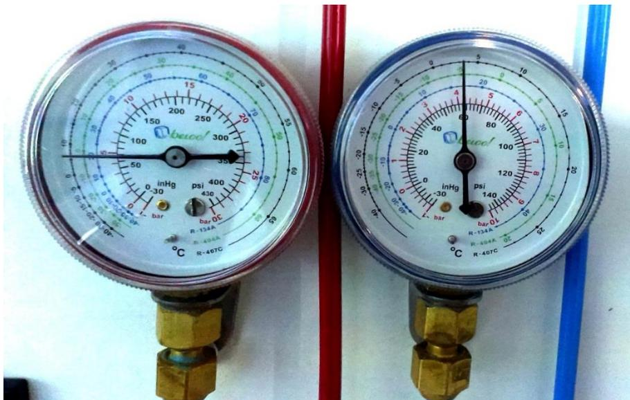
Рисунок 12 - Внешний вид приборов для измерения давления и температуры хладагента теплового насоса.
