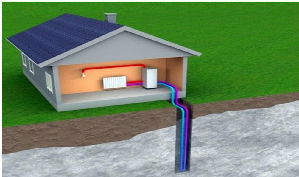
Рисунок 3 - Тепловой насос, отбирающий тепло от грунта
